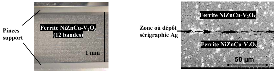
Figure 4-38 : photos réalisées sur l'empilement «6 bandes NiZnCu-V 2 O 5 / Ag / 6 bandes NiZnCu-V 2 O 5 » : (à gauche) image optique de l'empilement - (à droite) image MEB de l'empilement.
