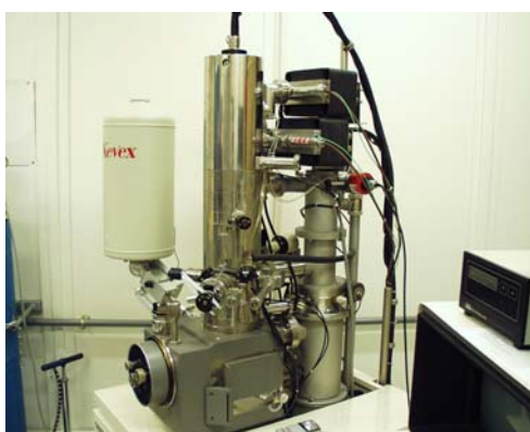
Figure D-5 : MEB Topcon ABT-150F équipé d'une chaîne de mesure EDS Kevex/Noran, utilisé pour les analyses élémentaires EDS.
