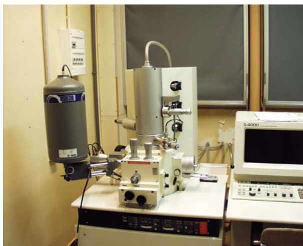
Figure D- 4: Microscope à balayage Hitachi S4000 utilisé pour l'imagerie.
