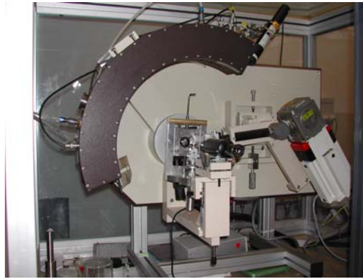
Figure D-2 : Diffractomètre INEL CPS120 utilisé pour la diffraction des rayons X sur poudres.
