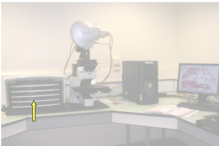
Figure 25 : Station de travail pour l'acquisition des images et la navigation sur lame virtuelle . Le chargeur automatique de lames est sur la gauche (flèche).
