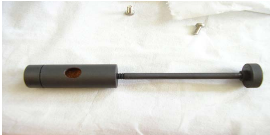
Figure II-9 : Container en graphite du four Cuivre avec une des tiges de fixation.
