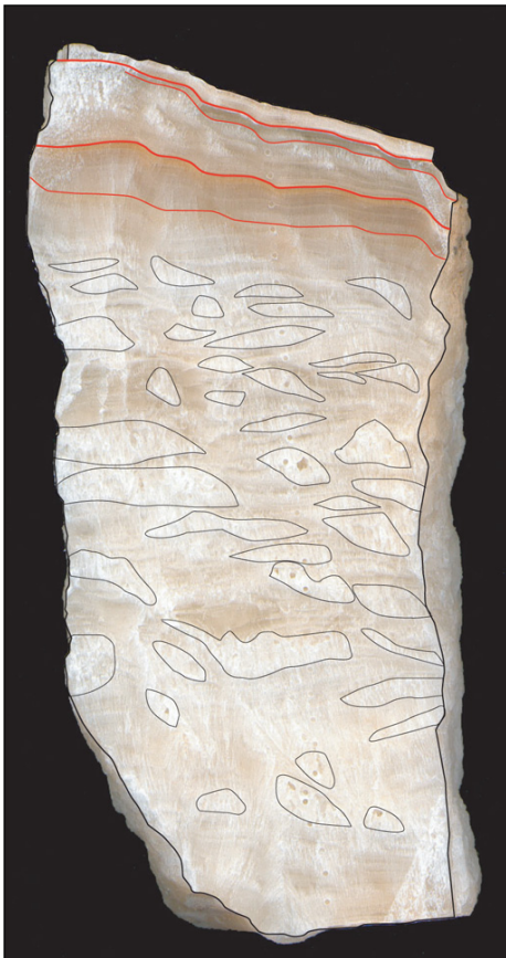
Figure 47. Distribution sur la section polie du plancher BDinf2 des lentilles de cristaux colonnaires associées à une forte porosité intercrystalline et interprétées comme des mini-gours.
