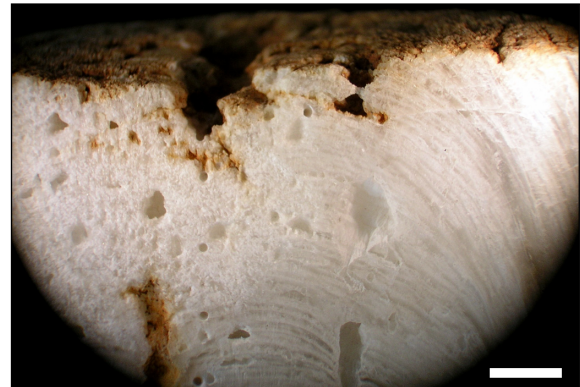
Figure 75. Sommet érodé de BDsup et porosité développée dans la zone axiale.
