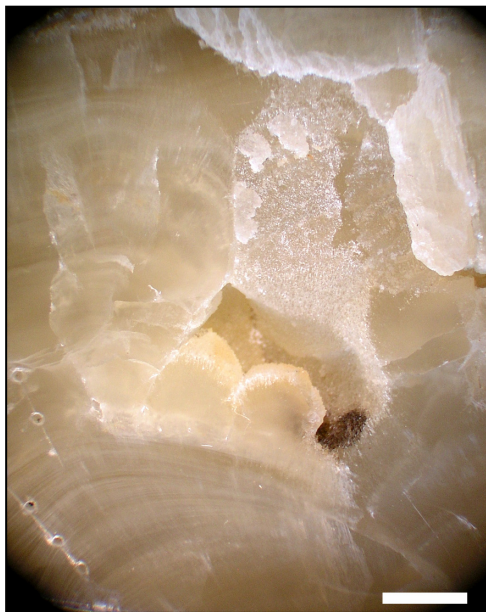
Figure 50. Vacuole située dans l'axe de croissance, probablement due au piégeage d'eau.
