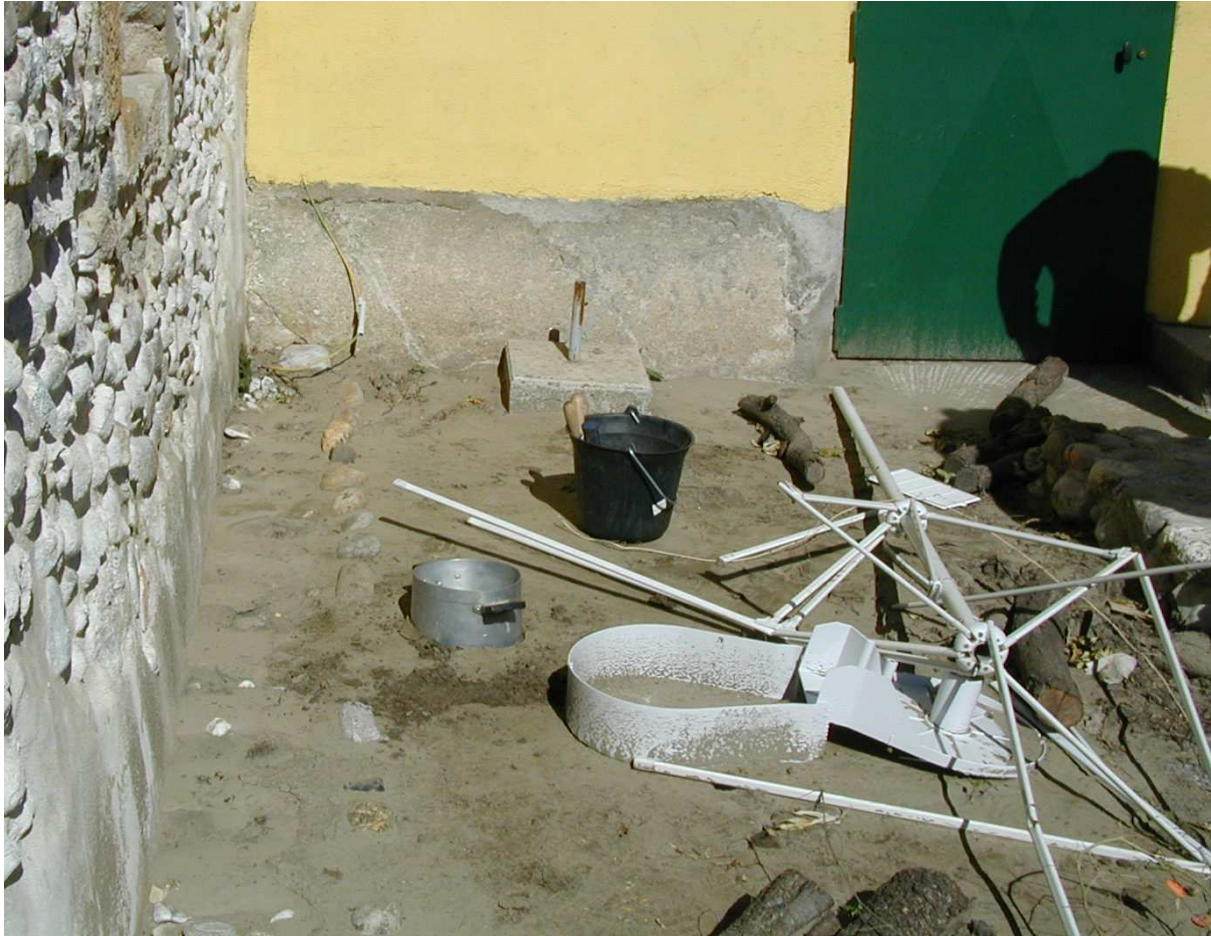
Photo 4 : Illustration de la technique de prélèvements, avec le faitout, des échantillons permettant de définir l'épaisseur des dépôts de la crue de 2002.
