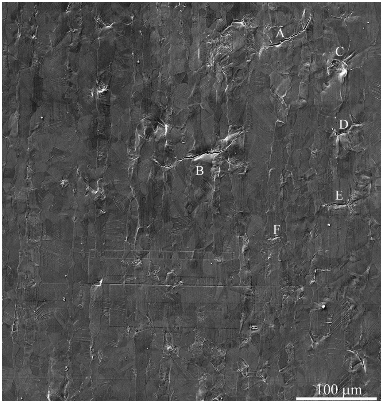
Figure IV-19. Principales microfissures observées dans l'acier duplex étudié ( \Delta\varepsilon/2=0,5\% , \dot{\varepsilon}=10^{-3}\text{ s}^{-1} : éprouvette 1 à 1693 cycles (a) ; éprouvette 2 à 2300 cycles (b)
