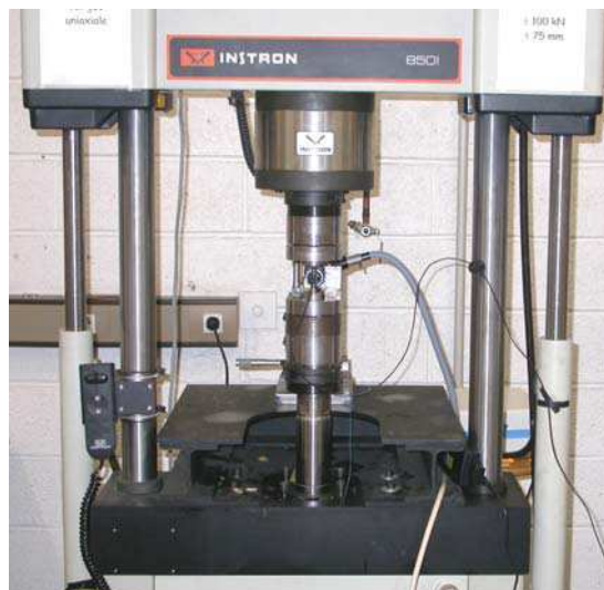
Figure I-17. Machine d'essai de fatigue uniaxiale.
