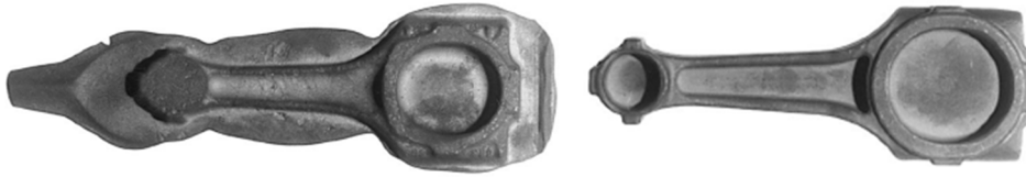
Figure 9 : Comparaison forge conventionnelle, forge de précision [DOE 00]
