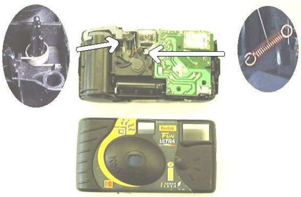
Figure I.10 Les ressorts dans un appareil photo jetable
