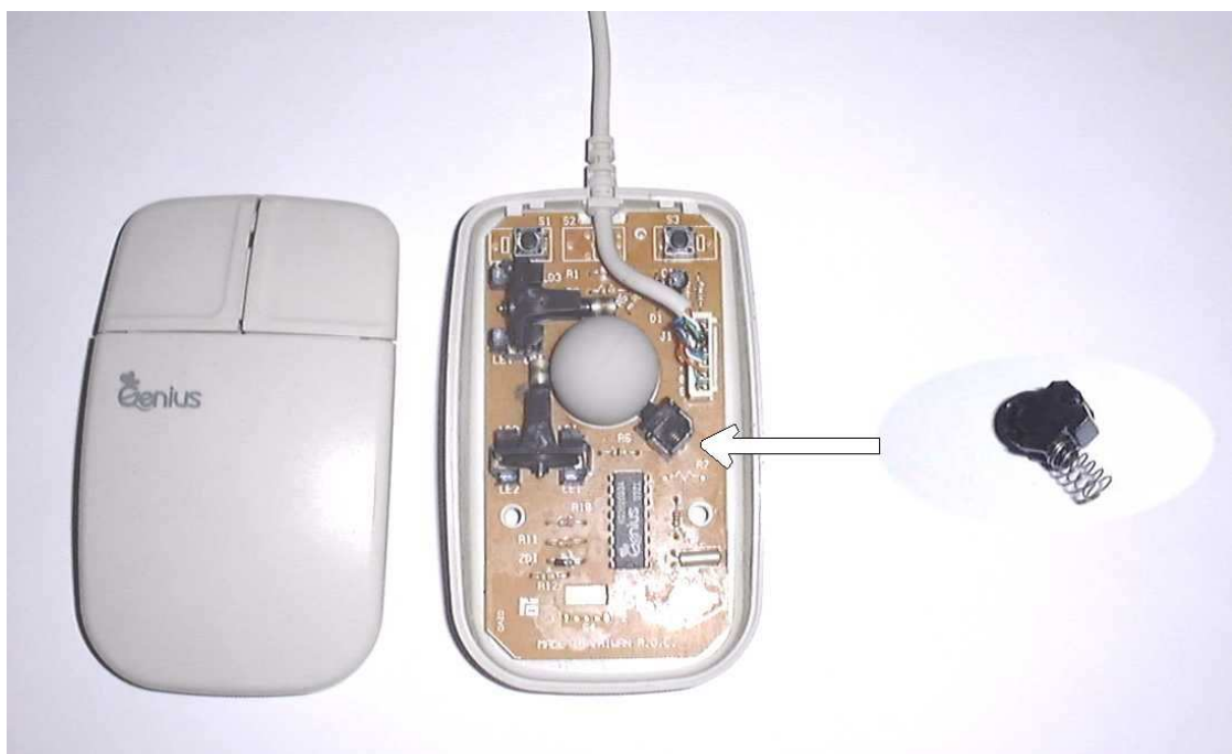
Figure I.9 Le ressort de compression dans une souris d'ordinateur
