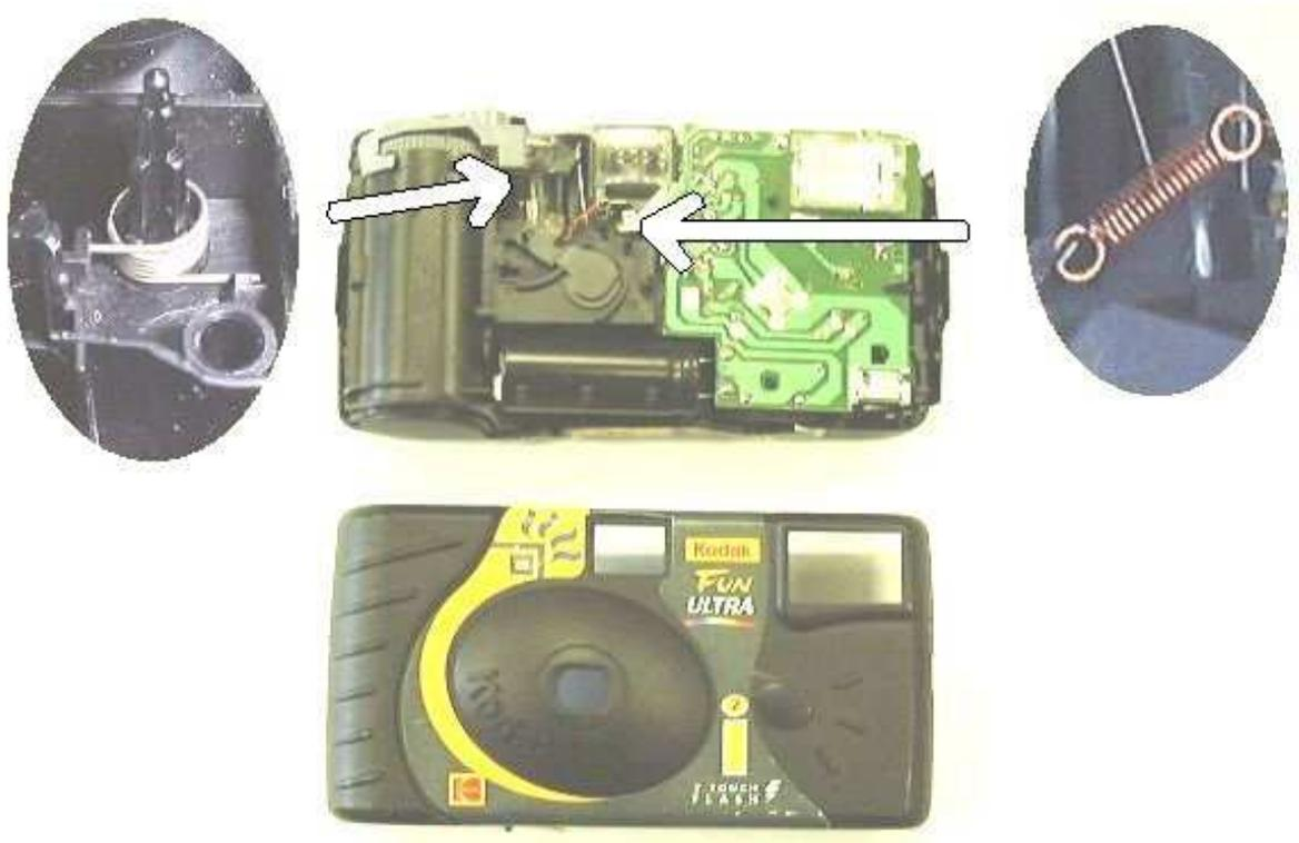
*Figure I.10 Les ressorts dans un appareil photo jetable*
