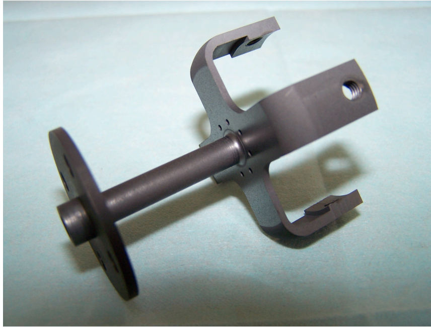
Figure V.3 : Tube ioniseur en carbone utilisé dans le cadre de SISTHE d'une longueur de 20 mm et d'un diamètre de 4 mm.
