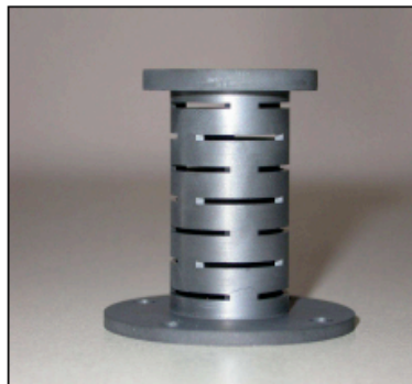
Figure II.10 : Four en carbone de l'ECS TARGISOL pouvant accepter jusqu'à 2,5 kW de puissance.
