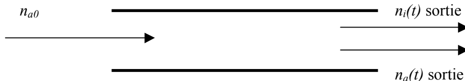
Figure III.5 : Schéma du tube ioniseur. Les atomes injectés dans un tube ioniseur à t égal à 0 ont une probabilité d'être ionisés, et une probabilité de rester neutres. Les ions ont également une probabilité de se neutraliser sur les parois du tube ioniseur.
