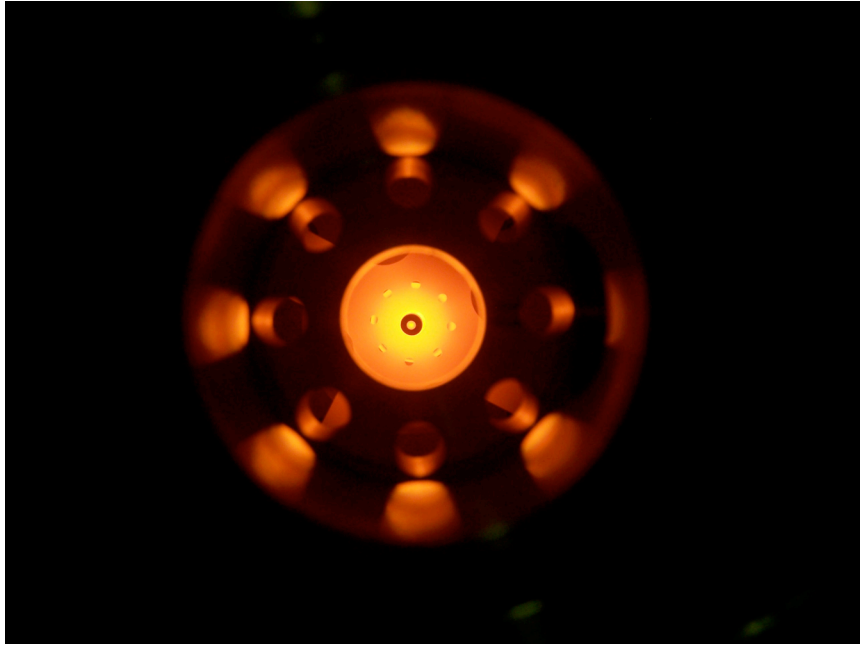
Figure V.4 : Vue du tube ioniseur de la source à ionisation de surface SISTHE prise côté extraction (puissance ioniseur de 700 W, température égale à 1700°C).
