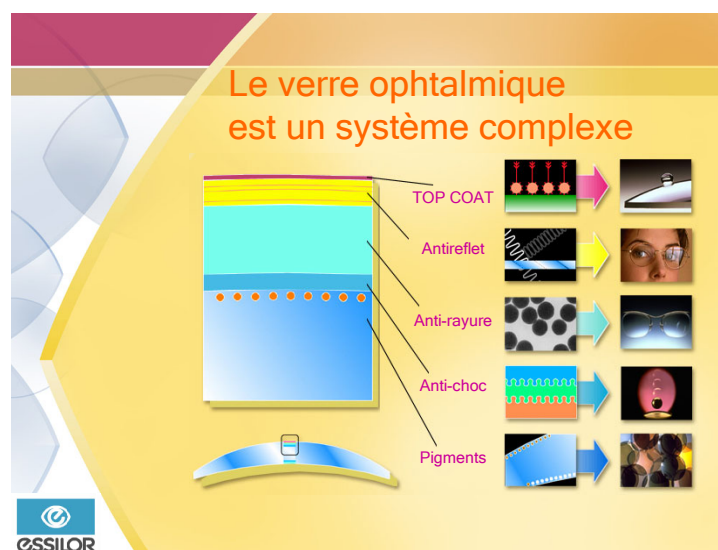
Figure 1.1 : Stratification du verre ophtalmique (Source : présentation R&D interne)
