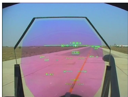
Figure 4.3 : Exemple d'affichage tête haute (HUD) pour avion de chasse.
