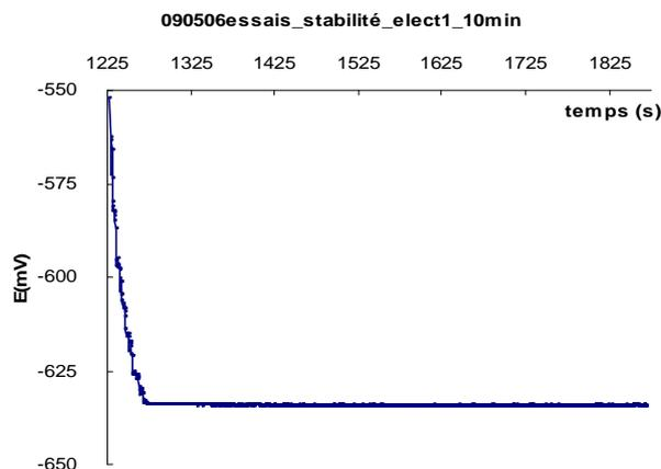
Figure IV.4 : Stabilité signal sur 10 minutes.
