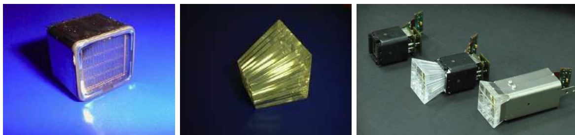
FIG. 2.4 – Système de photodétection, avec à gauche, un photomultiplicateur sur lequel on peut voir la structure en 4 \times 4 pixels, un guide de lumière associé (figure du centre), et enfin trois des étapes de construction du système de photodétection (PMT et électronique de lecture (troisième plan), avec guide de lumière (deuxième plan), et avec blindage (premier plan)).
