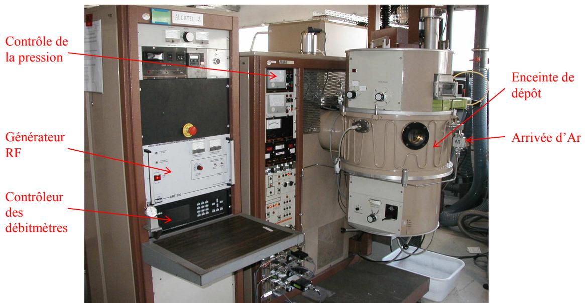
FIG 2.5 – Enceinte de dépôt par pulvérisation cathodique.
