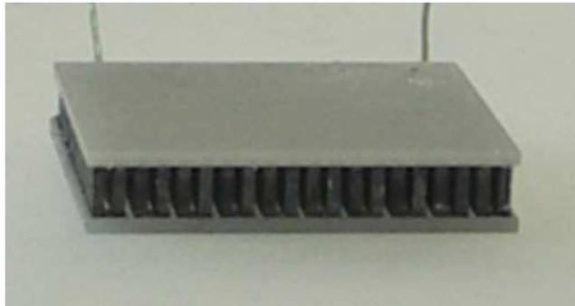
FIG 1.7 – Photo d'un convertisseur thermoélectrique à base de  $\text{Bi}_2\text{Te}_3$  massif.
