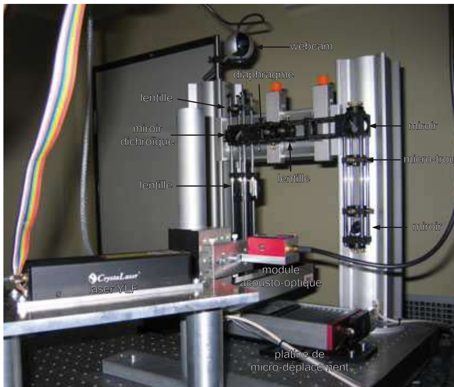
Figure 3.13 – Photo de notre nouveau banc d'inscription laser pulsé
