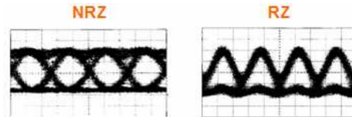
Figure 12. Différences entre œil NRZ et œil RZ
