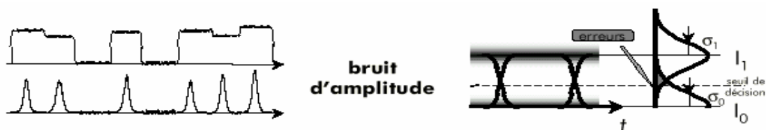
Figure 13. Diagramme de l'œil réel : bruit d'amplitude (d'après [123])
