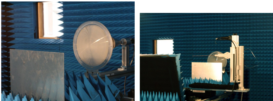
FIG. 3.18: Aperçu du dispositif de mesure du champ rayonné. Une plaque métallique est placée devant la lentille. Les mesures de champs sont effectuées derrière la plaque.
