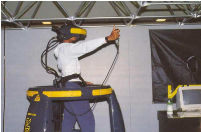
Photo 24 : première station de réalité virtuelle dédiée au jeu de W Industries. Le traqueur de position se trouve dans la plate-forme.
