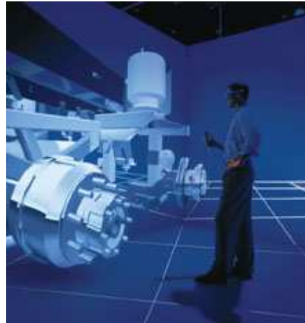
Photo 6 : image rendue par l'action combinée du relief et du système CAVE de la société Fake Space. Ici, on assiste à une étude mécanique en image de synthèse.
