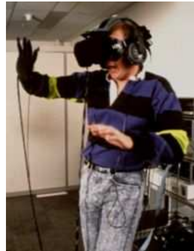
Photo 25 : un des premiers types de visiocasques et gant de donnée mis sur le marché par VPL research.
