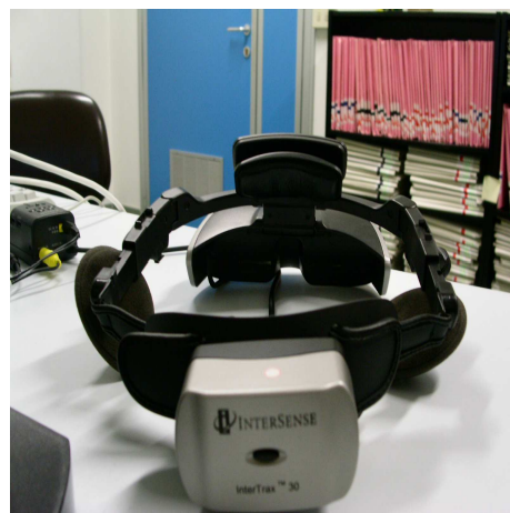
Photo 11: Un tracker gyroscopique (Intertrax 2 ) fixé sur la partie postérieure d'un visiocasque (Sony Glasstron).
