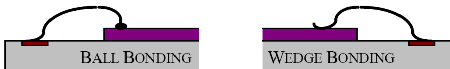
Figure IV.35 Deux techniques de wire bonding
