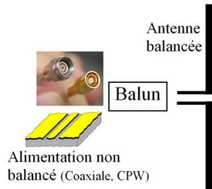
**Figure IV.13 Configuration d'un système équilibré par le balun**
