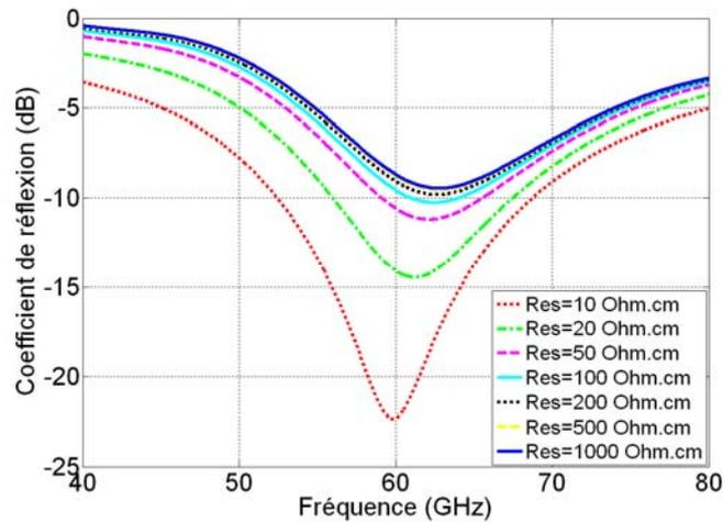
**Figure III.10** Coefficient de réflexion de l'antenne dipôle intégré sur substrat de silicium pour différentes valeurs de résistivité
