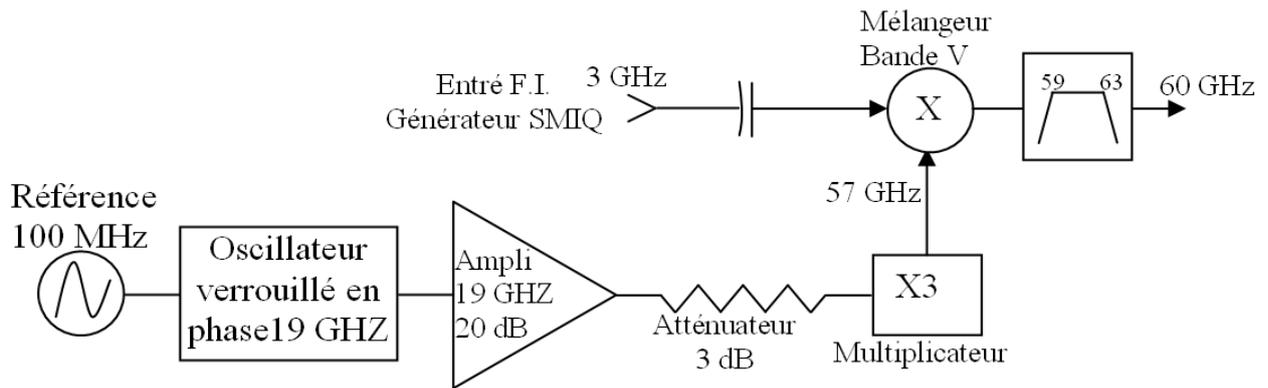
Figure IV.46 Schéma synoptique du système d'émission millimétrique [IV.25]
