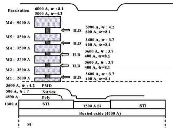
Figure III.8 Topologie de la technologie SOI
