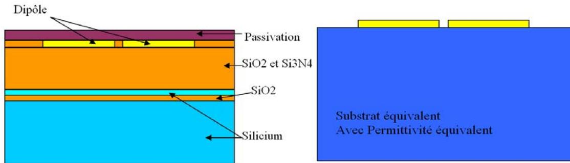
Figure II.33 Substrat Equivalent de la technologie SOI
