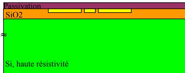
Figure II.16 Coupe équivalente de substrat CMOS SOI
