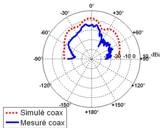
Figure IV.72 Diagramme de gain de l'antenne IFA
