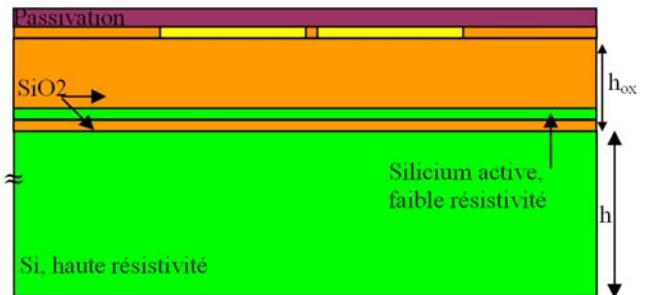
Figure III.15 Antenne dipôle intégrée sur la couche M6 de la technologie SOI
