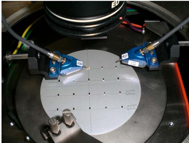
Figure IV.31 Mesure des paramètres S de l'antenne avec sonde sous pointes
