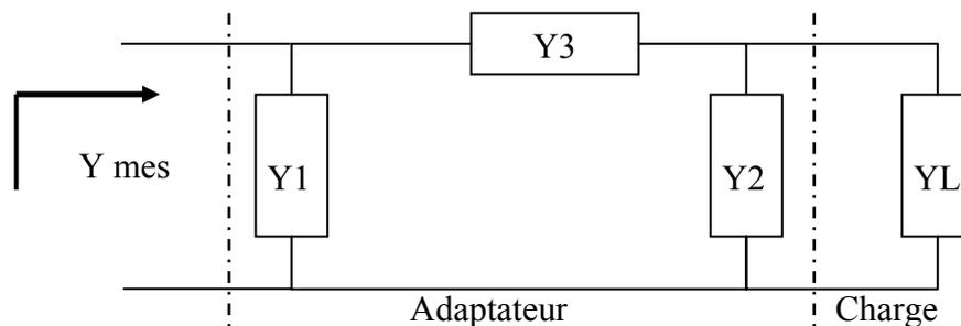
Figure IV.39 Circuit équivalent de l'adaptateur et des charges
