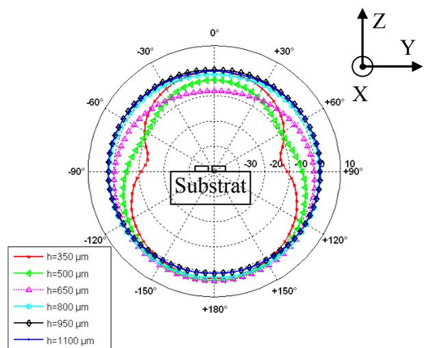
**Figure III.23** Gain de l'antenne dipôle en changeant l'épaisseur de silicium,  $\phi=90$
