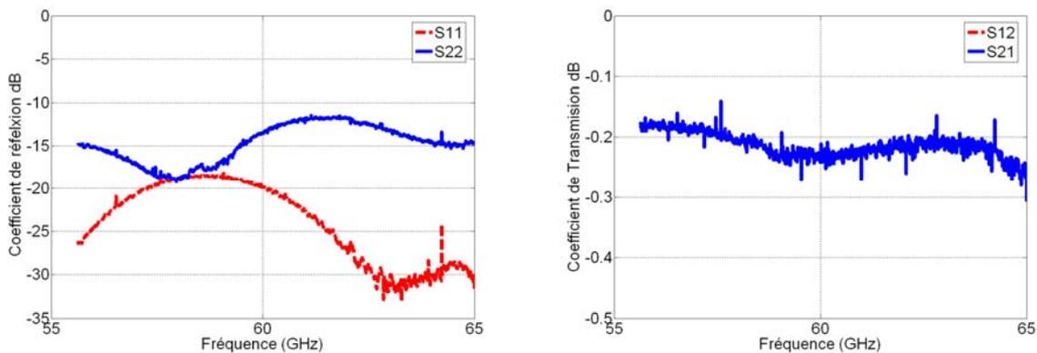
Figure IV.40 Paramètres  $S$  de l'adaptateur après calcul
