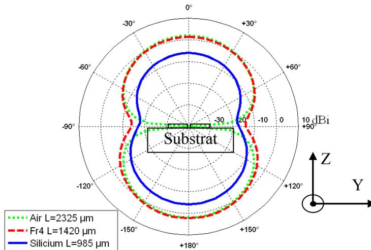
Figure III.7 Gain de l'antenne dipôle pour différents substrats
