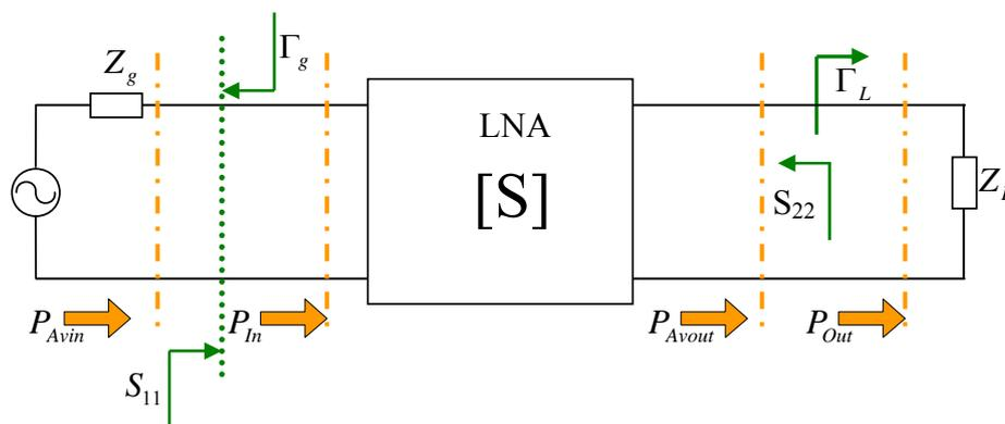
Figure IV.109 Représentation des puissances autour de l'amplificateur
