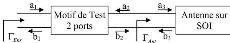
Figure IV.44 Procédure d'épluchage des paramètres de l'antenne
