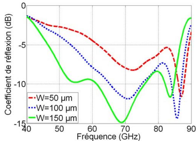
**Figure IV.98 Coefficient de réflexion de l'antenne spirale : Changement de largeur de brins**
