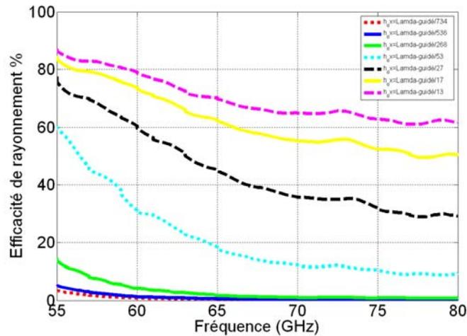
Figure III.35 Effet de l'épaisseur de la couche d'oxyde sur l'efficacité de rayonnement d'une antenne pastille imprimée
