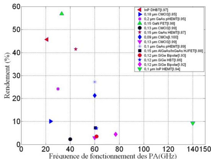
Figure I.11 Rendement des PA en différentes technologies
