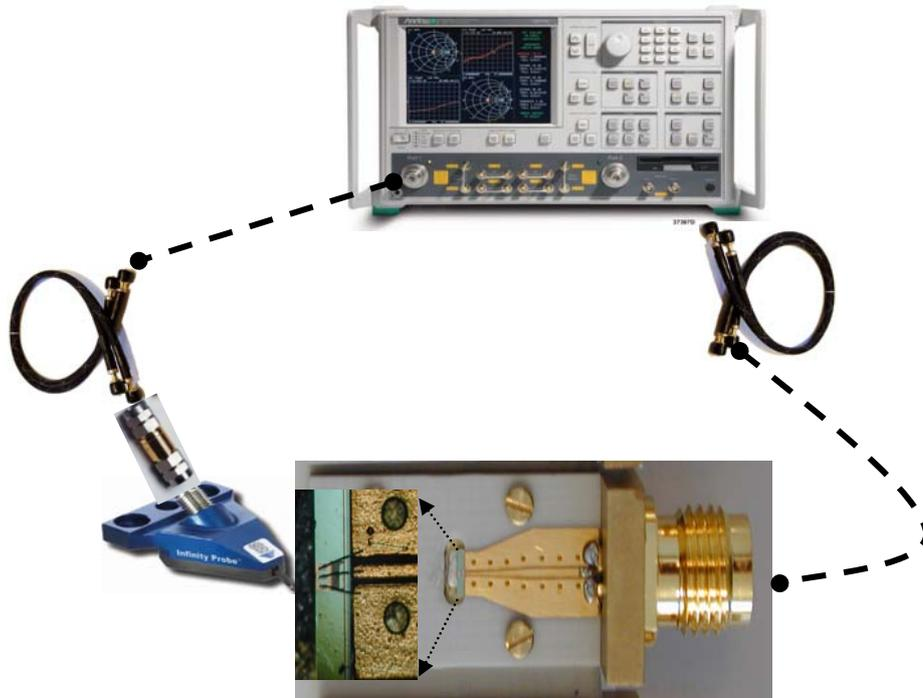
Figure IV.38 Schéma de méthode utilisé pour la caractérisation de motif de test
