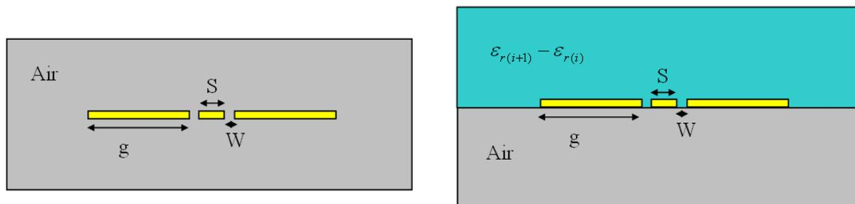
**Figure II.9 Configuration pour trouver la capacité**
