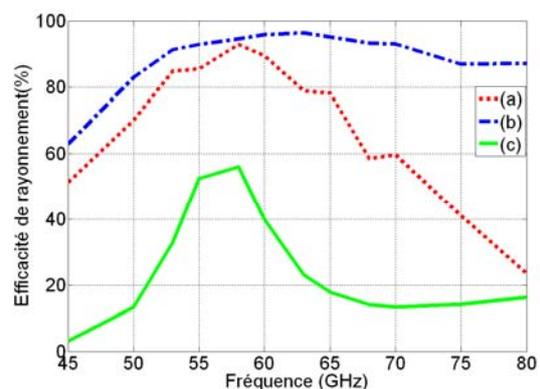
Figure IV.28 Effet du balun sur l'efficacité de rayonnement du dipôle
