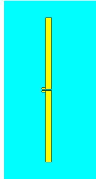
Figure III.3 Antenne dipôle
