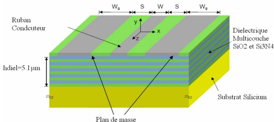
**Figure II.4 Ligne de transmission Guide d'onde coplanaire CPW**
