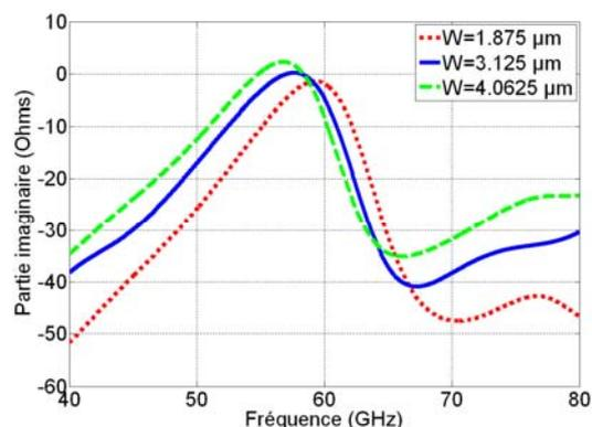
Figure IV.9 Comparaison de l'effet de largeurs des doigts sur la partie imaginaire de l'impédance de dipôle
