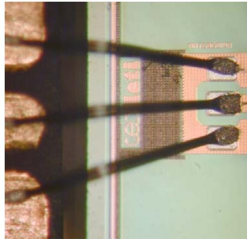
**Figure IV.36 Schéma des fils à métallisation coplanaires**
