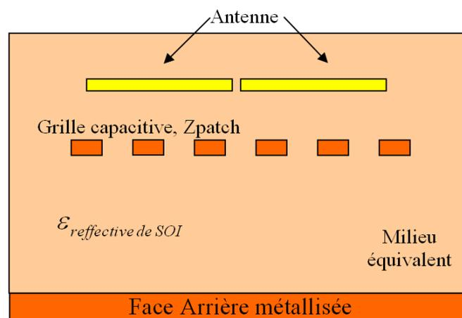
Figure III.44 Grille dans un milieu guidé (SOI)
