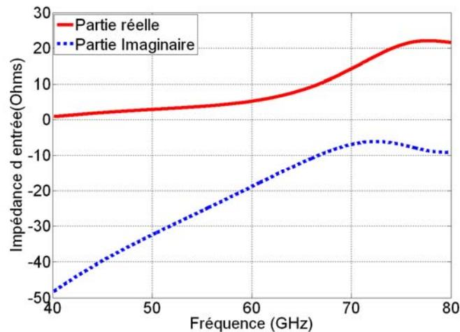
**Figure IV.111 Impédance d'entrée de dipôle simple avec alimentation de ruban coplanaire**
