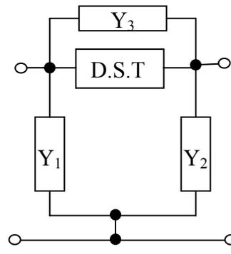
Figure II.36 Modèle de D.S.T. avec des plots d'accès
