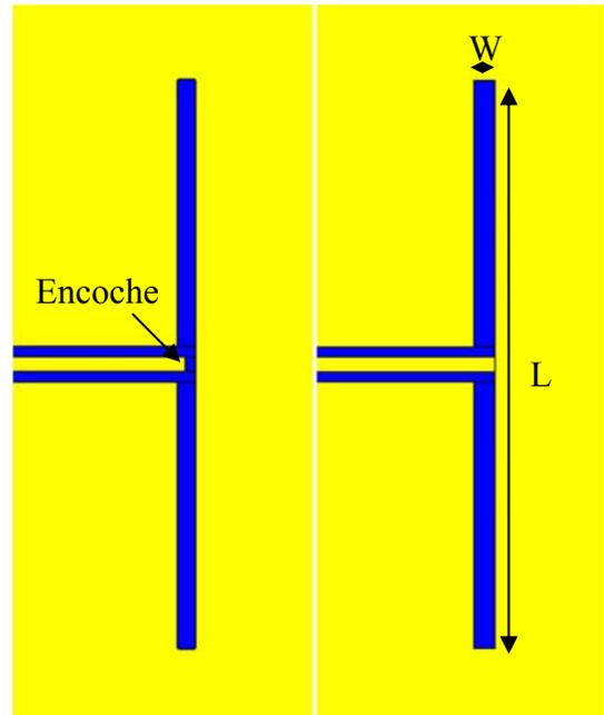
**Figure IV.77** Antenne fente alimentée par ligne CPW
