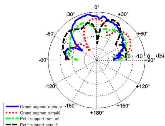
Figure IV.55 Diagramme de gain de l'antenne interdigitée Plan E « polarisation croisée »
