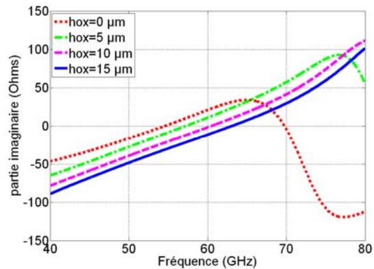
**Figure III.18** Effet de la couche d'isolant sur la partie imaginaire de l'impédance d'entrée de l'antenne
