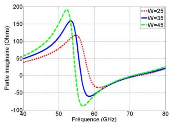
**Figure IV.81** Evolution de la partie imaginaire d'impédance d'entrée d'une fente simple
