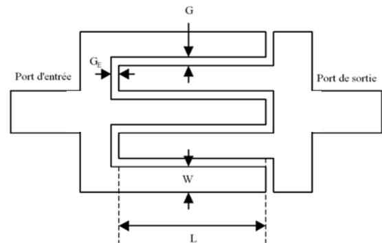
**Figure IV.3 Géométrie de la capacité interdigitée en série**
