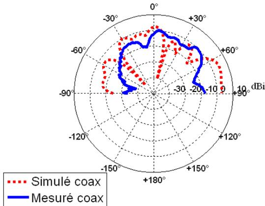
Figure IV.71 Diagramme de gain de l'antenne IFA
