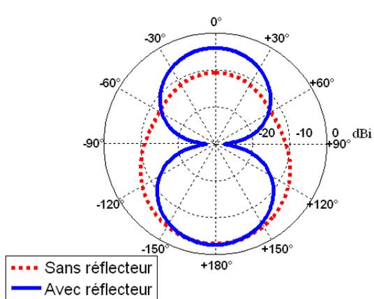
Figure IV.85 Diagramme de gain de l'antenne Fente, plan H
