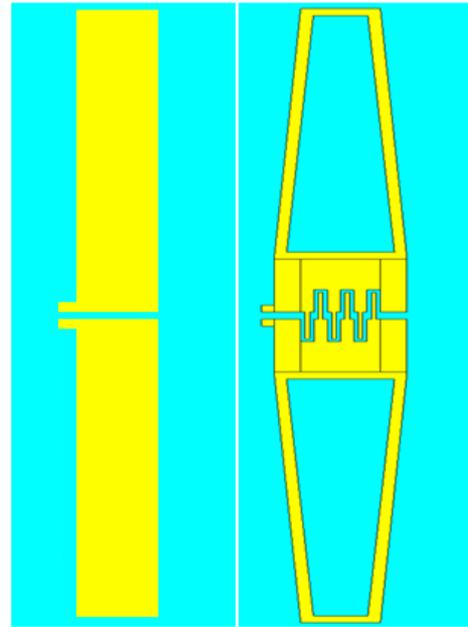
Figure IV.4 Structure de l'antenne dipôle
