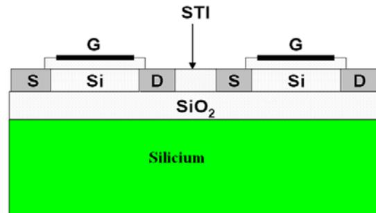
Figure I.17 Isolation diélectrique totale entre les transistors.
