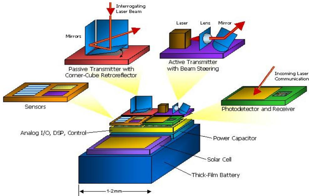
Figure I.2 Architecture d'un nœud Smart Dust[I.2]
