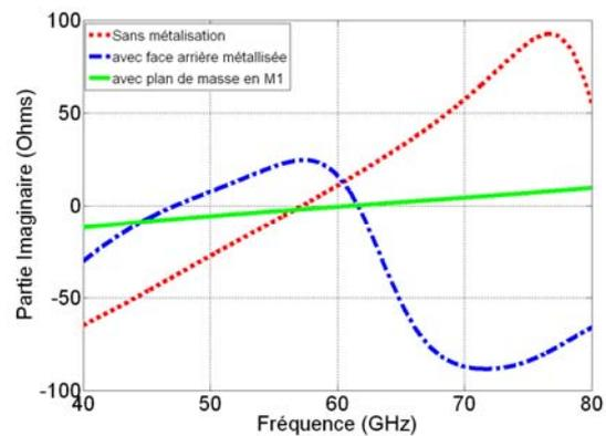
**Figure III.30** Effet de plan de masse proche de l'antenne sur sa partie imaginaire d'impédance d'entrée
