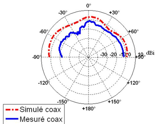
Figure IV.53 Diagramme de gain de l'antenne interdigitée avec petit support Plan E
