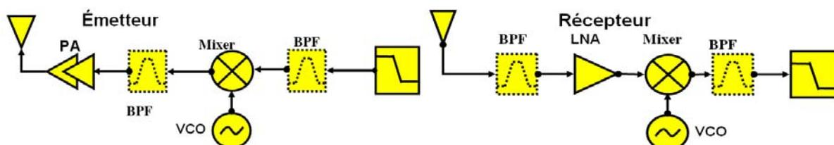
Figure I.3 Différents composants d'un émetteur/récepteur RF[I.129]
