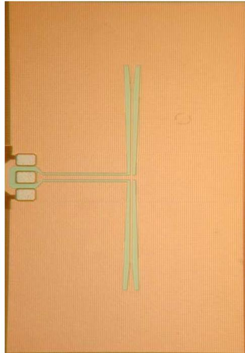
Figure IV.87 Antenne Double Fente intégrée sur SOI
