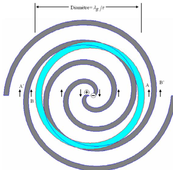
Figure IV.96 Distribution de courant dans une antenne spirale
