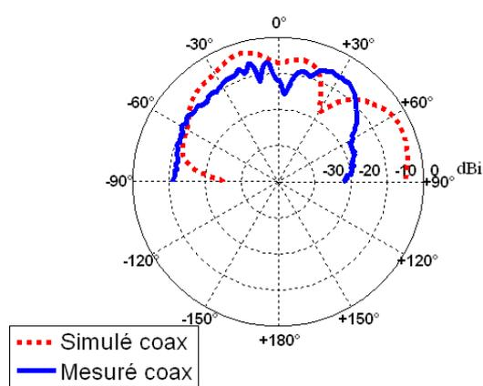
Figure IV.70 Diagramme de gain de l'antenne IFA
