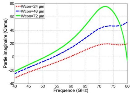
**Figure IV.114 Effet de  $W_{con}$  sur la partie imaginaire de l'impédance d'entrée de l'antenne de conception conjointe**
