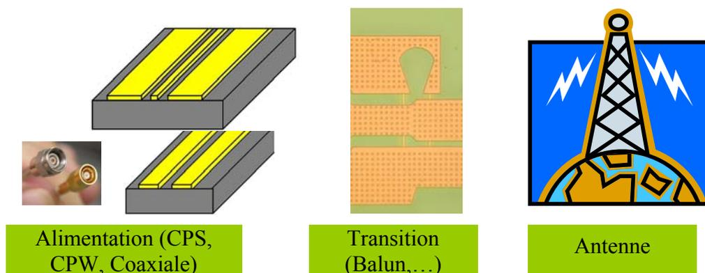
Figure II.1 Différents composants pour la conception de l'antenne
