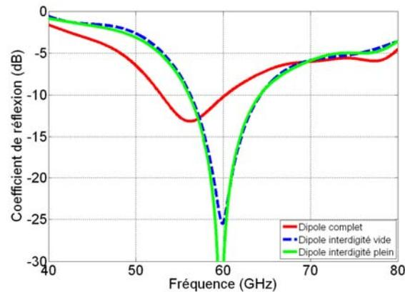
Figure IV.7 Comparaison de coefficient de réflexion de l'antenne pour différentes configurations
