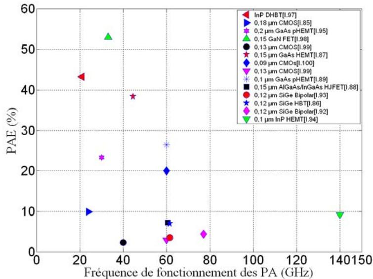
Figure I.12 Rendement globale des PA en différentes technologies
