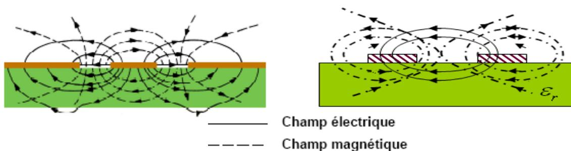
Figure II.7 Représentation schématique des champs dans les lignes CPW et CPS
