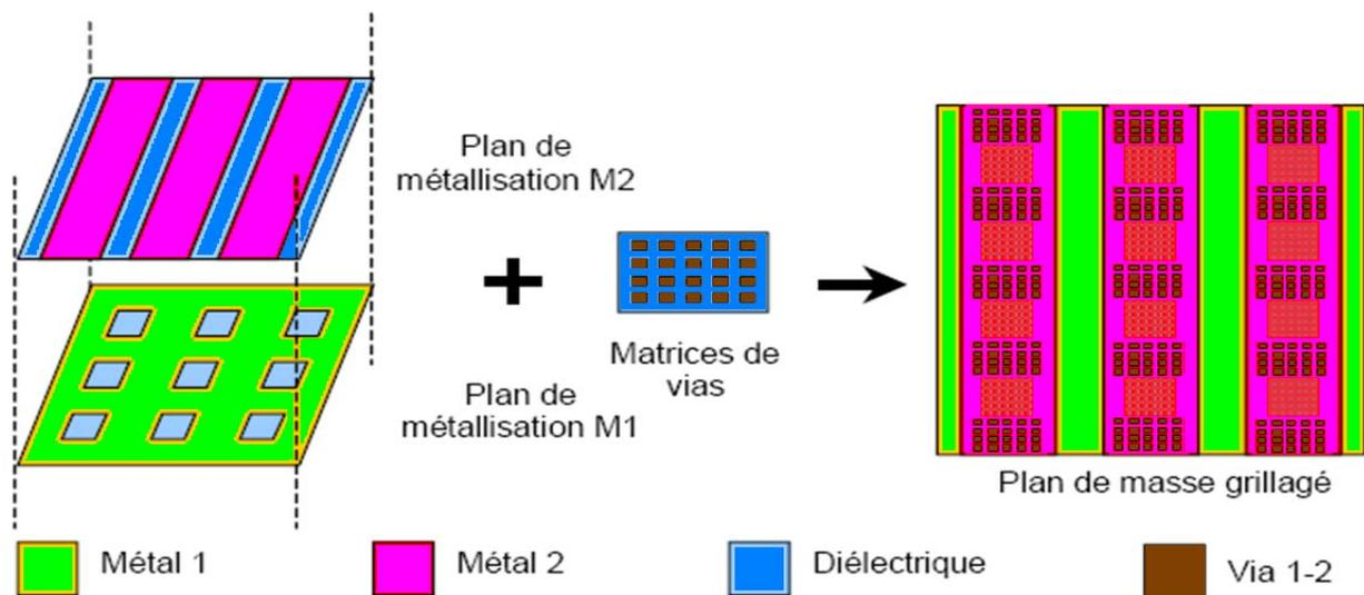
Figure II.5 Schéma du plan de masse grillagé
