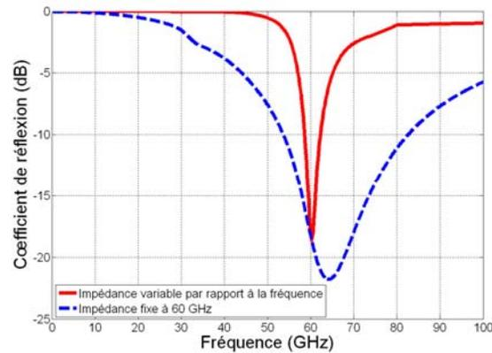
Figure IV.121 Comparaison des coefficients de réflexion S11 avec différente impédance de référence
