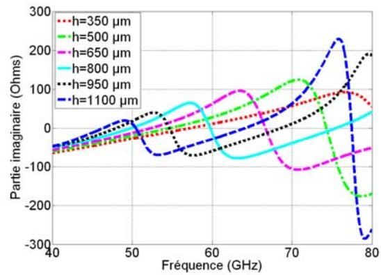
**Figure III.21** Effet de l'augmentation de l'épaisseur de Silicium sur la partie imaginaire de l'impédance d'entrée de
