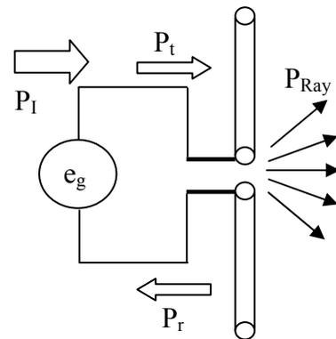
Figure III.1 Efficacité de rayonnement et efficacité de l'antenne
