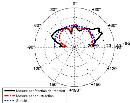
**Figure IV.57** Diagramme de gain de l'antenne interdigitée au niveau de substrat SOI, Plan H
