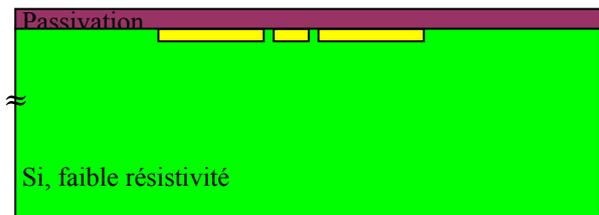
Figure II.18 Coupe équivalente de substrat CMOS
