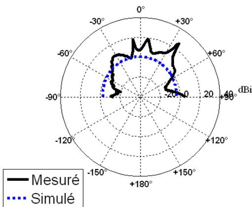
Figure IV.75 Gain de l'antenne IFA au niveau de
