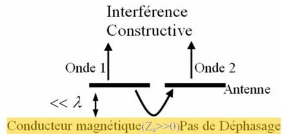
Figure III.40 Antenne placée près d'un conducteur magnétique
