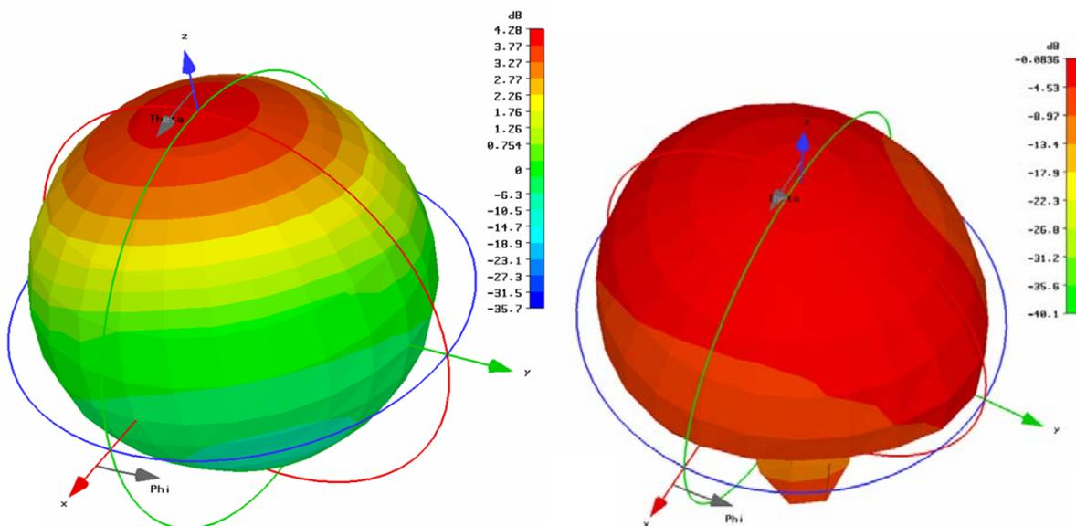
Figure IV.105 Diagramme de rayonnement de l'antenne spirale
