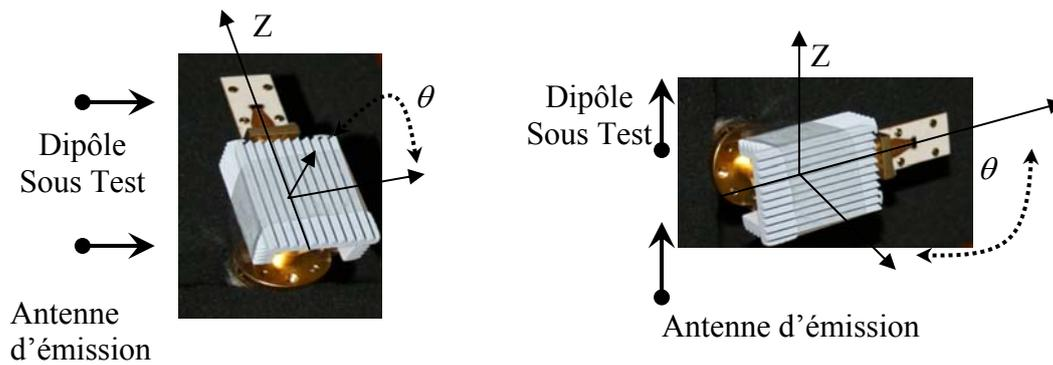
Figure IV.91 Plans de coupe de l'antenne Fente
