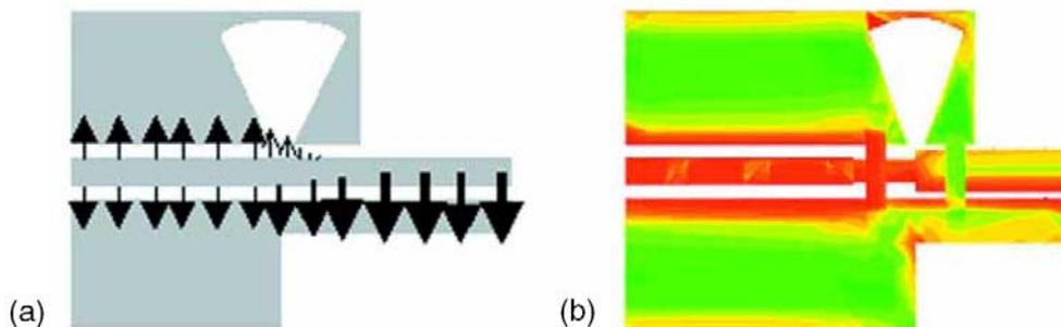
Figure IV.16 (a) Modèle de champ électrique pour le balun de CPW à CPS
