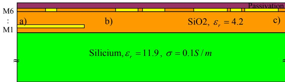
**Figure II.3 Différentes structures d'interconnexion sur SOI**
