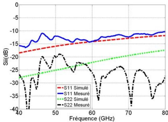
Figure IV.19 Coefficient de réflexion du balun (S11&S22)
