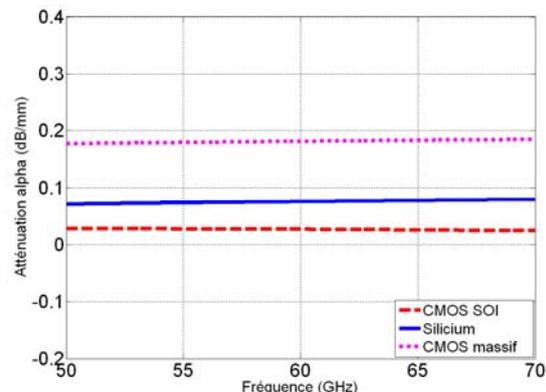
Figure II.20 Simulation de l'atténuation de ligne CPW (w=29 μm, g=10 μm)
