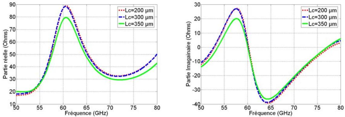
**Figure IV.63** Effet de l'espace entre le court circuit et l'alimentation  $L_c$  sur l'impédance d'entrée de l'antenne IFA
