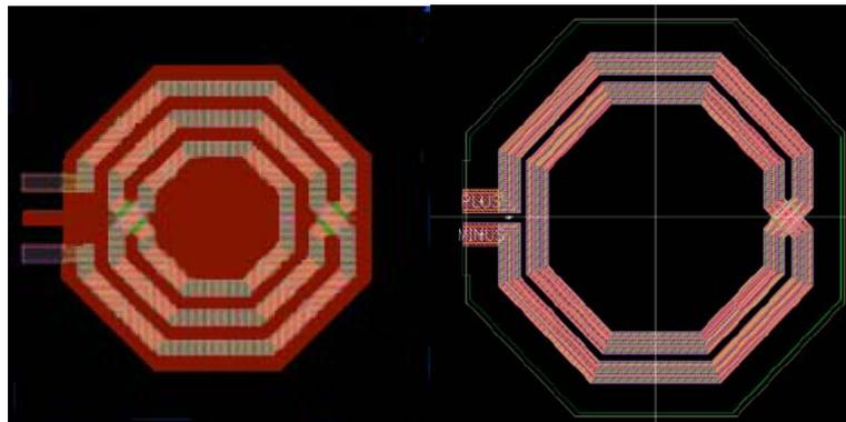
Figure I.19 Inductance spirale intégrée de  $3.4 \text{ nH}$  sur CMOS [I.127]
