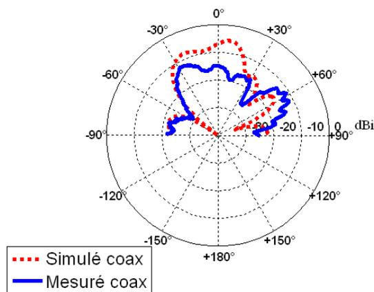
Figure IV.69 Diagramme de gain de l'antenne IFA
