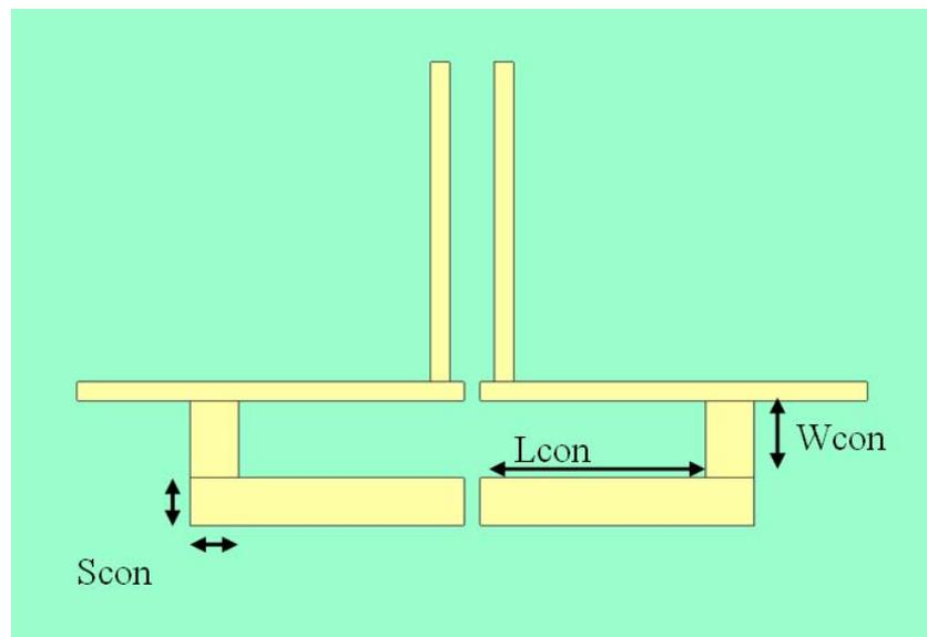
**Figure IV.112 Antenne dipôle repliée pour la conception conjointe**
