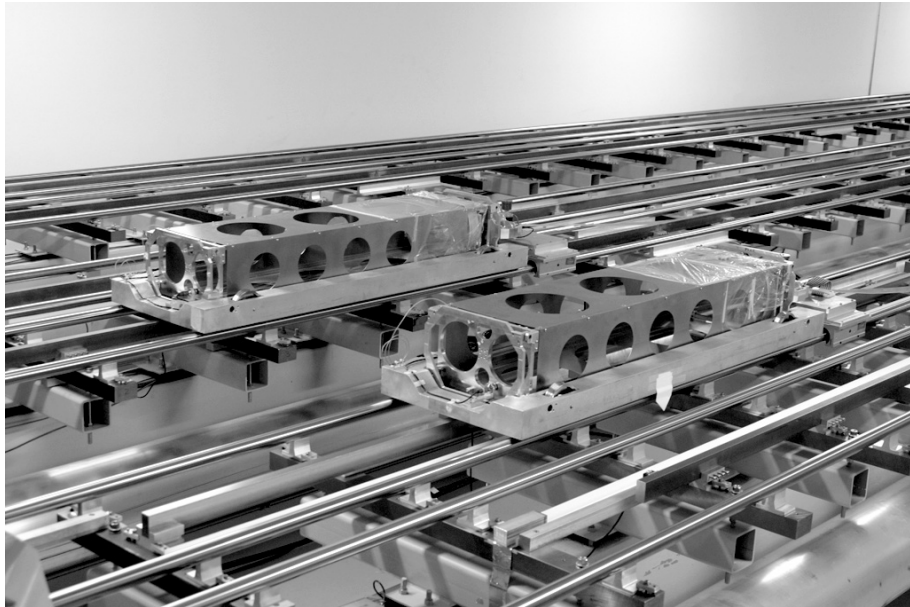
FIG. 2.9 – Deux chariots mobiles des lignes à retard de CHARA.
