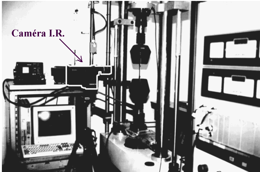
FIG. 1.1 – Photo du dispositif expérimental. On distingue, sur la gauche le système d'acquisition Infrarouge, au centre la machine d'essai et à droite son système de commande (Dartec 9500).
