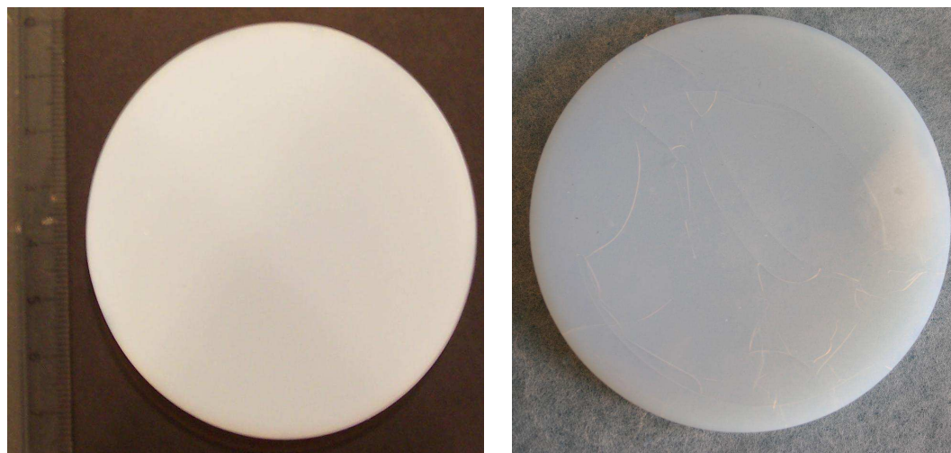
FIG. V.14 – Echantillons monolithiques d'aérogel de silice sain (à gauche) et fissuré (à droite)
