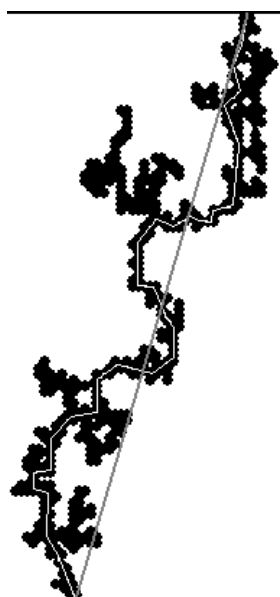
FIG. III.7 – Illustration du calcul de la tortuosité, le chemin réel parcouru par le flux de chaleur entre deux points dans le solide est en blanc et la droite entre les deux mêmes points est grise
