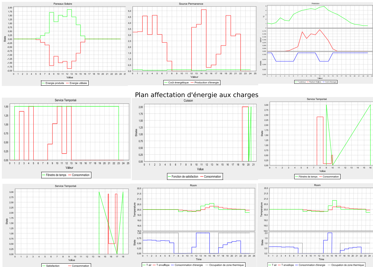
FIG. 10.5 – Résultats d'affectation des ressources d'énergie dans le mode de confort avec la stratégie de consommation locale de l'énergie produite
