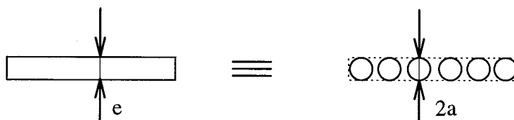
Figure VI.2 - Le diamètre des fils équivalents est égal à l'épaisseur e .
