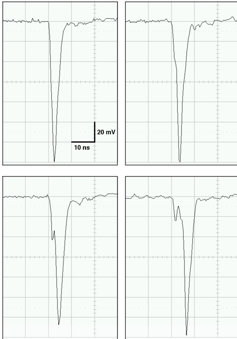
Figure 38 : différentes formes de signaux délivrés par une RPC en mode streamer pour une haute tension de 9,2 kV. En haut à gauche : streamer en coïncidence en temps avec l'avalanche. En bas à droite, streamer retardé par rapport à son précurseur.
