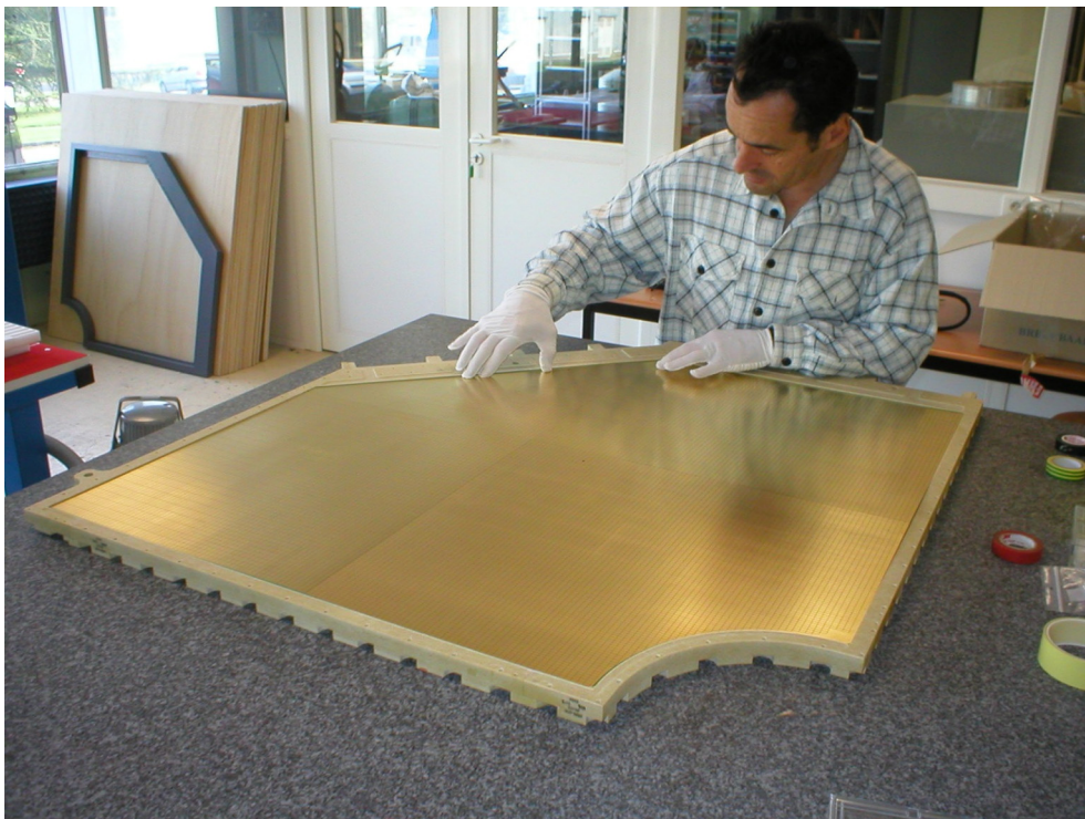
Figure 60 : assemblage d'un des deux plans cathodiques lors de la construction du premier quadrant de la station 1.
