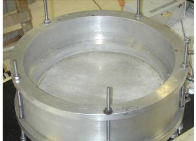
(o) unidade superior assentada sobre amostra de GCL
