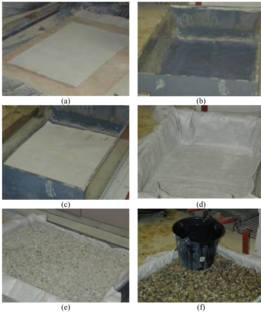
Figura 7.4. Hidratação sob confinamento de amostras de GCL destinadas aos ensaios de interface com geomembranas: (a) amostra de GCL cortada; (b) tanque de confinamento com manta geotêxtil no fundo; (c) colocação da amostra de GCL no interior do tanque; (d) geotêxtil de proteção superposto à amostra de GCL; (e) confinamento realizado por brita graduada; (f) inserção de água de hidratação do GCL.
