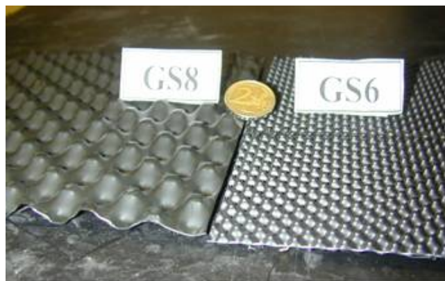
Figura 6.9. Geoespaçadores empregados no programa de pesquisa.
