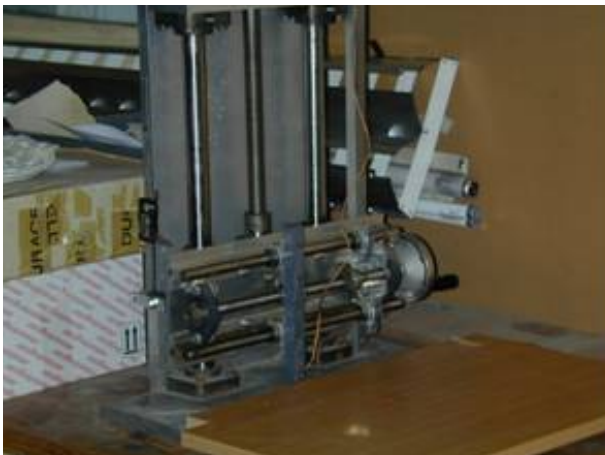
(a) espeçômetro de precisão
