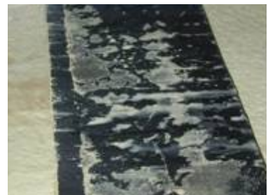
(c) interface Geomembrana PEADc-GCL BF dessecado sujeita a escoamento de água
