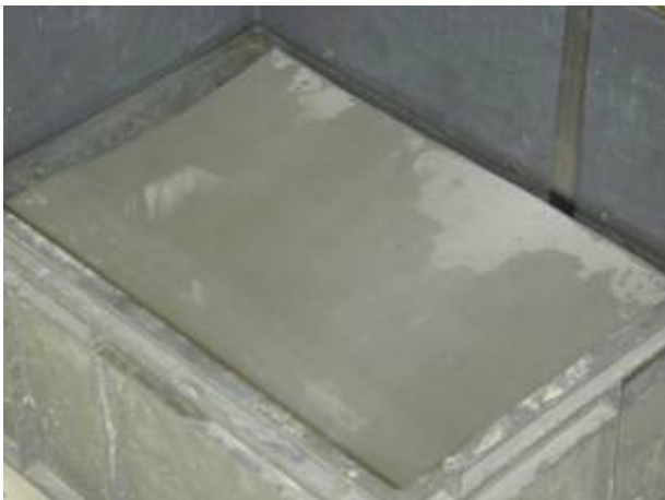
(c) immersion de l'échantillon dans le bac (5 cm d'eau).
