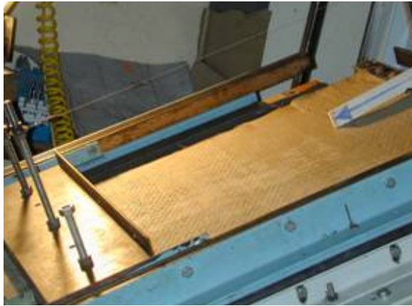
(a) interface Géomembrane PEHDc-GCB BF hydraté
