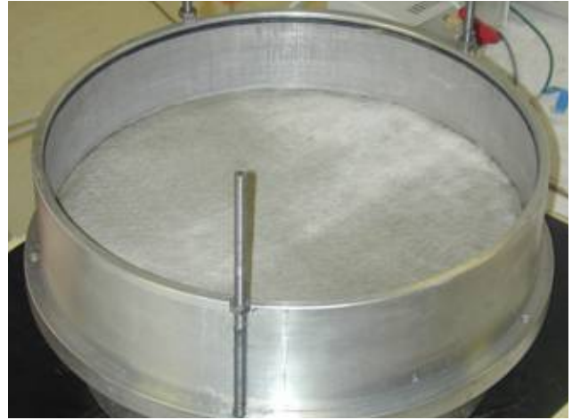
(h) mise en place du GCB
