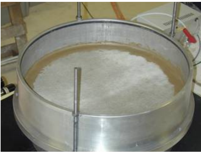
(i) étanchéité latérale avec la bentonite
