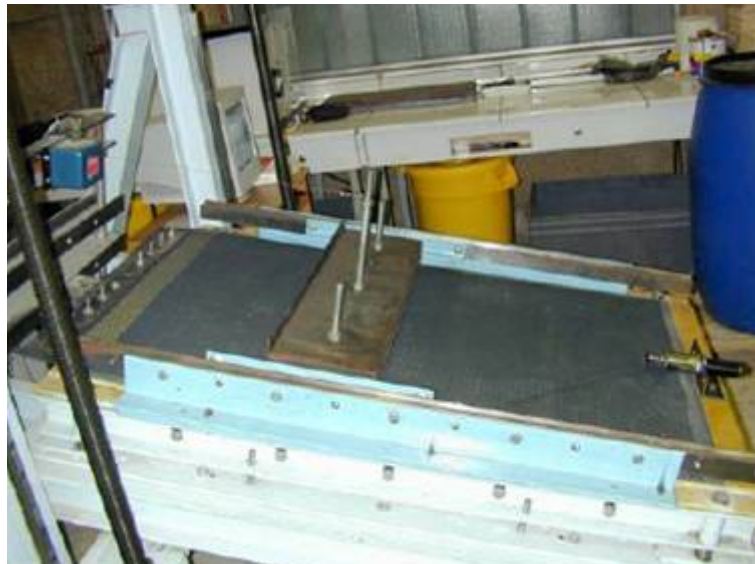
(a) equipamento de ensaio « plano inclinado » com sistema de placa móvel
