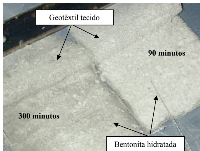
Figura 7.17. Distribuição de umidade ao longo da componente bentonita dos GCLs BF destinados aos ensaios de interface com o geoespaçador de 8 mm a \sigma_v=5,1 kPa.
