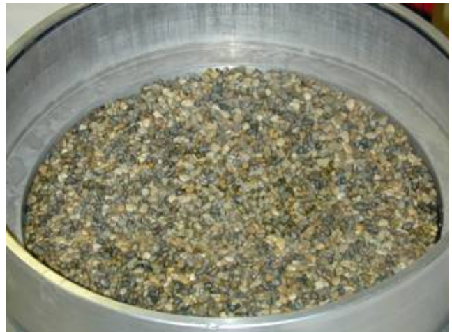
(f) vista superior do conjunto pedra porosa-unidade intermediária
