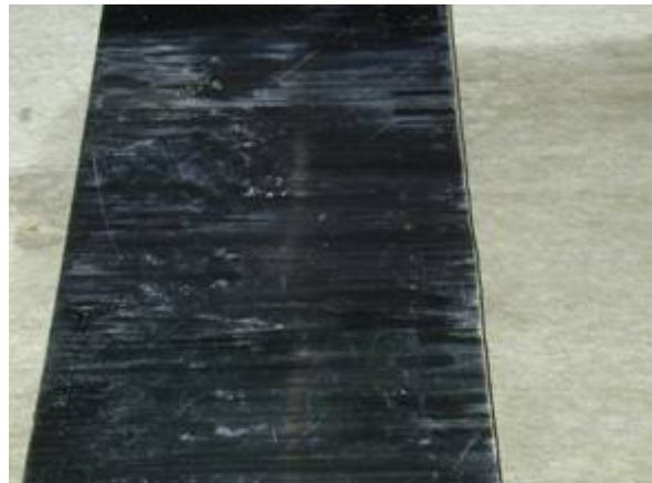
(b) interface Geomembrana PEADc-GCL BF dessecado
