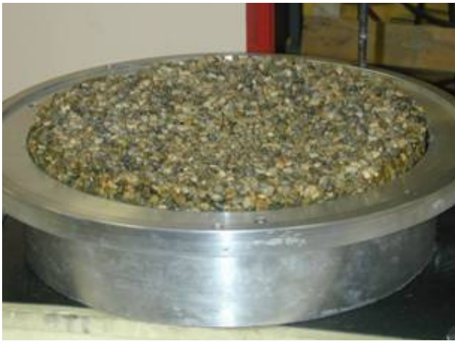
(a) cellule inférieure et pierre poreuse
