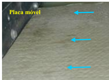
(c) interface Geomembrana PEADc-GCL BF dessecado sujeita a escoamento de água
