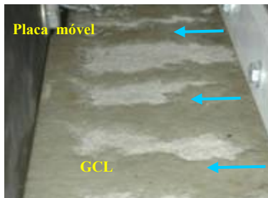
(c) interface Geomembrana PEADc-GCL BF dessecado sujeita a escoamento de água
