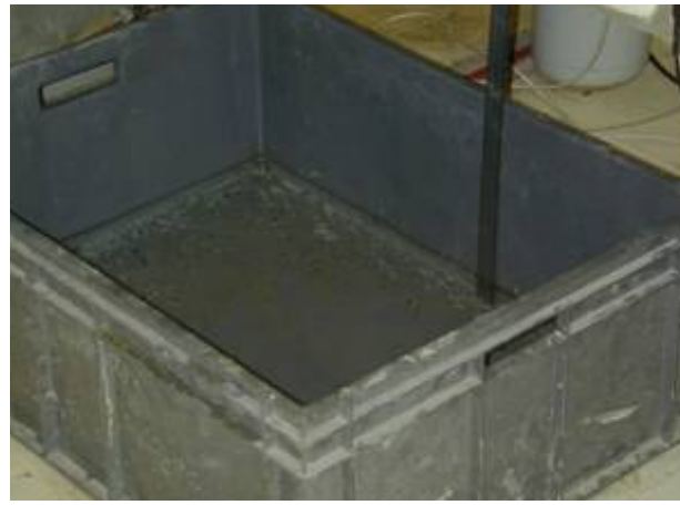
(b) tanque de imersão preenchido com 5 cm de coluna d'água
