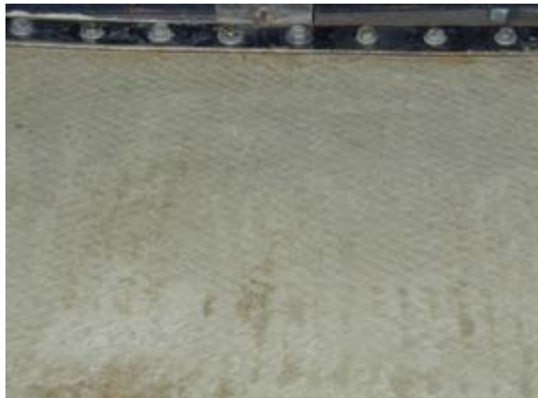
(b) interface Geomembrana PEADc-GCL BF dessecado
