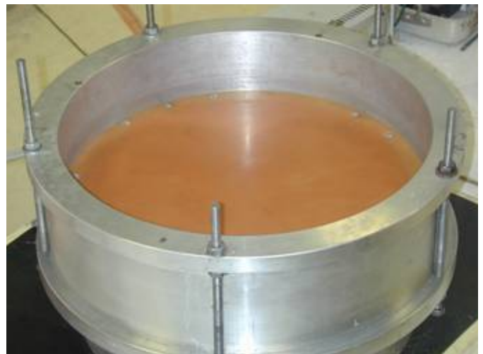
(q) membrane d'étanchéité au-dessus du sable
