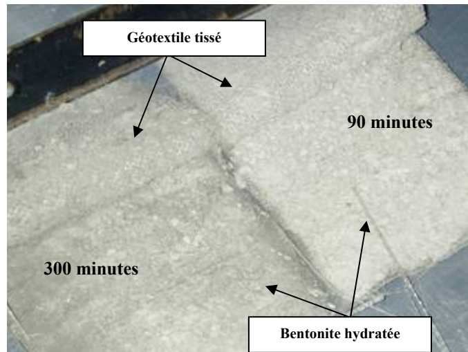
Figure 7.17. Distribution d'humidité le long de la composante bentonite des GCBs BF destinés aux essais d'interface avec le géospaceur de 8 mm à \sigma_o=5,1 kPa.
