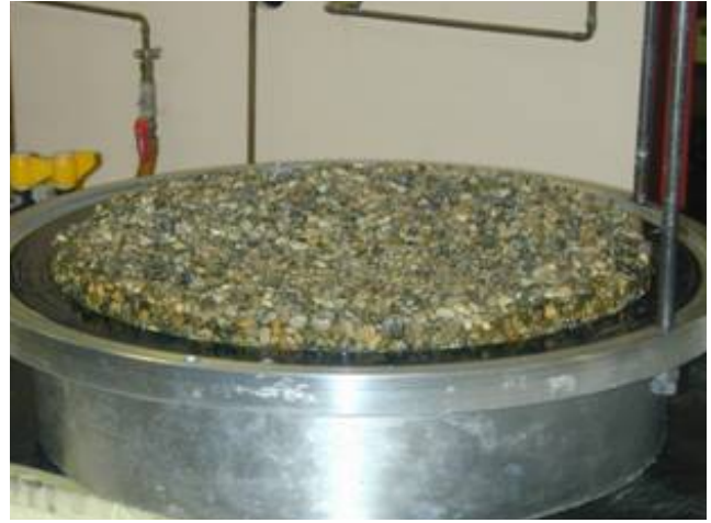
(b) colocação da membrana de estanqueidade
