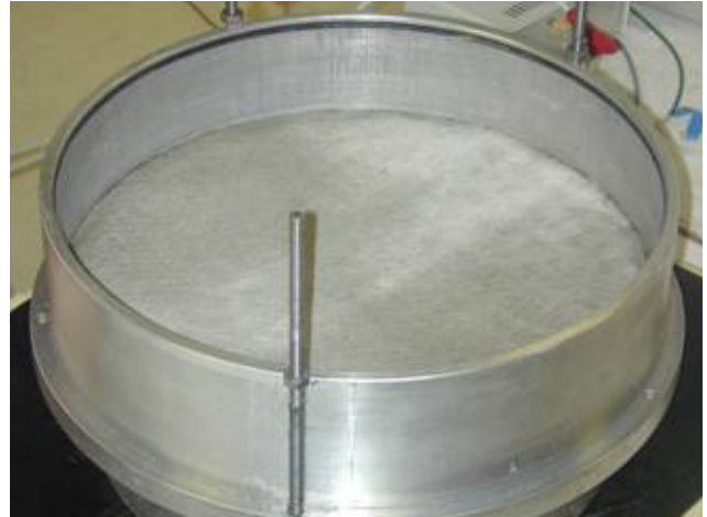
(h) colocação da amostra de GCL indeformada
