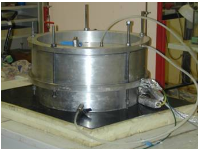
(r) cellule assemblée et tuyaux de connection à la bouteille de gaz et au panneau de contrôle
