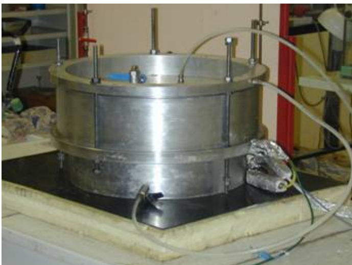
(r) conjunto montado com sistema de confinamento conectado à tampa superior
