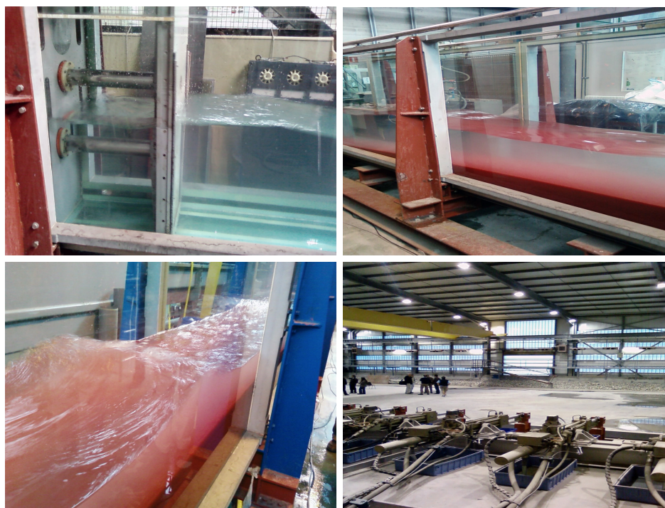
FIG. 6.1 – En haut à gauche : La partie offshore du canal à houle du LEGI - Le batteur sert à générer la houle au large ; En haut à droite : Vue de côté du canal à houle du LEGI - Le sable (en rouge) est transporté par la houle. En bas à gauche : Déferlement de la houle à l'approche du rivage ; En bas à droite : Le bassin à houle de la SOGREAH (30m x 30m) où la plage de Sète sera reproduite en échelle réduite.
