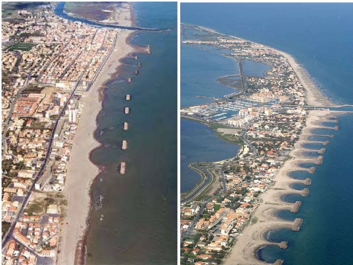
FIG. 1.3 – (Gauche)- La succession de 10 brise-lames le long de la plage de Valras ; (Droite)- Le lido de Frontignan avec sa succession spectaculaire d'une quarantaine d'ouvrages.
