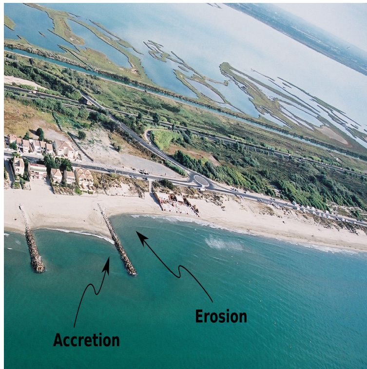
FIG. 1.2 – Une exemple d’implantation classique d’épis, perpendiculaires à la côte. On peut apercevoir un mécanisme érosif du côté amont (par rapport à la dérive littorale) de l’ouvrage, alors qu’une accretion de sable se développe de l’autre côté (Crédits : Hugues Heurtefeux, EID-MED ).
