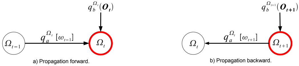
FIG. 5.7 : Modèle graphique représentant les propagations forward et backward crédibilistes entre deux instants où \Omega_t est l'ensemble des états.
