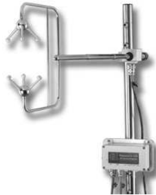
FIG. 3.1: Photo d'un anémomètre sonique 3D.
