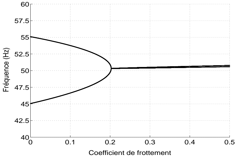
FIG. 4.2: Évolution des fréquences du système en fonction du coefficient de frottement
