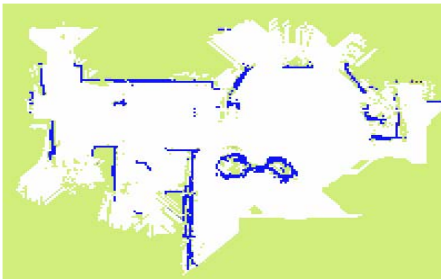
Figure (2.5). Exemple d'une grille d'occupation 2D construite dans notre laboratoire. Les valeurs d'occupation sont codées comme suit : (vert : inconnu ; blanc : libre ; bleu : occupé). La superficie est ( 10 \times 8 \text{ m}^2 ) ; une cellule correspond à ( 5 \times 5 \text{ cm}^2 ).
