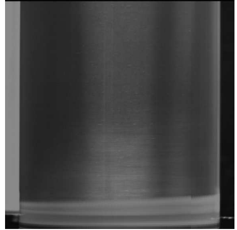
FIG. 3.2: Couche d'Ekman (partie claire) dans TC_{\eta_1} pour \omega_o = 7 tr/s et \omega_i = 0 .
