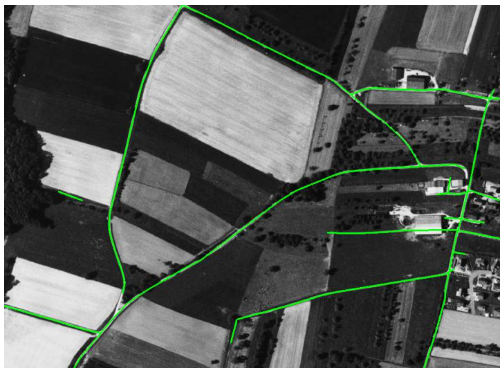
FIG. 3.20 – Résultats de l'extraction sur une image aérienne (figure 3.19).
