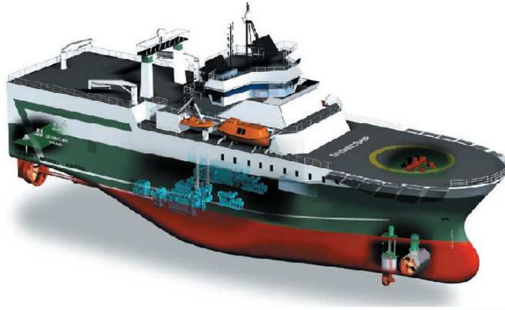
FIG. 1.1 – Propulseurs transversaux réalisant le plein actionnement du bateau.
