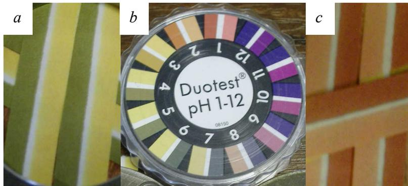
*Figure 14* Papier indicateur de pH double réactif avant (a) et après (c) exposition aux émissions d'un moteur d'avion, (b) code couleur pour l'interprétation de ce papier
