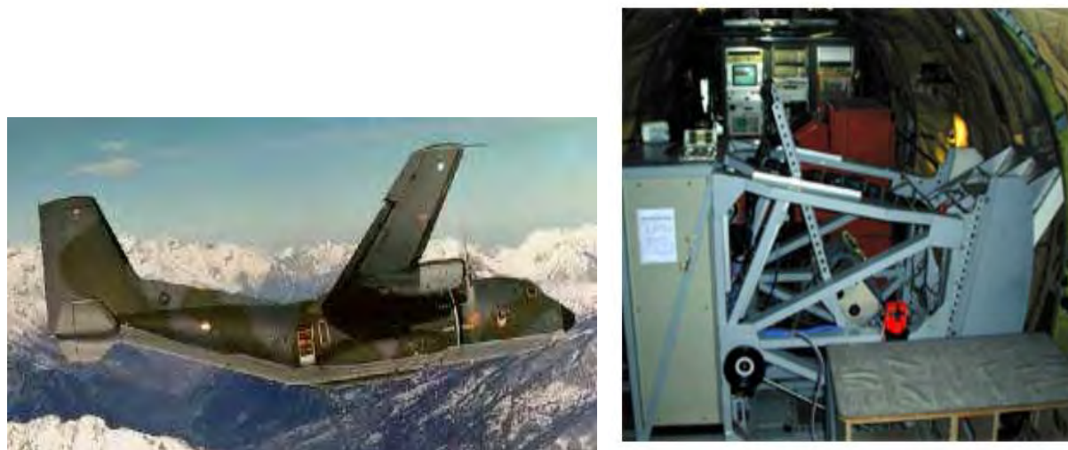
FIG. 4.4 – Capteur SAR RAMSES (à droite) embarqué à bord d'un Transall C160 (à gauche).
