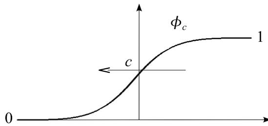
FIG. 2 – Profil et vitesse d'une onde progressive
