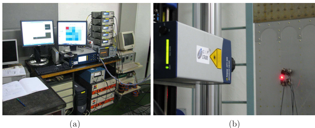
Figure 54 – (a) Instrumentation installée sur le site du centre aéronautique VZLU à Prague. (b) Vibromètre laser Polytec OFV-505 mesurant la vitesse à la surface de l'échantillon.
