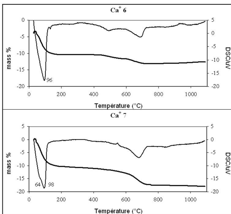
FIG. 20 – Analyses thermiques différentielles des bentonites calciques activées (6 et 7).
