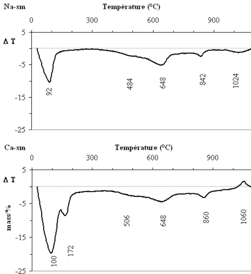
FIG. 2.14 – Analyses thermiques différenciées de Ca-sm et Na-sm
