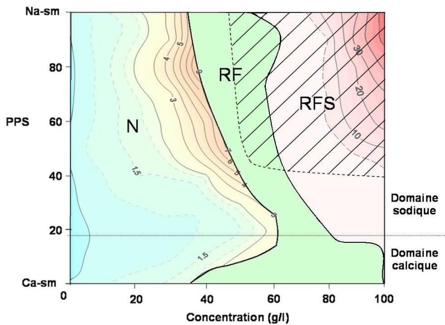
FIG. 4.30 – Evolution du comportement rhéologique des suspensions en fonction de la saturation et de la concentration. *N* : fluides newtonien, comprenant l'évolution de la viscosité relative, *RF* : fluides rhéofluidifiants, *RFS* : fluides rhéofluidifiants à seuil, comprenant l'évolution du seuil d'écoulement, zone hachurée : fluides thixotropes.
