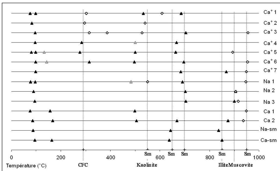
FIG. 5.2 – Répartition des pics exothermiques ( $\diamond$ ) et endothermiques ( $\blacktriangle$ ) au cours de la rampe de température pour chaque bentonite étudiée. Les points grisés ont une très faible intensité.
