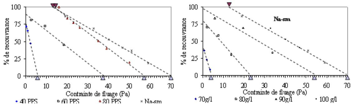
FIG. 4.8 – Evaluation de la limite d'élasticité ( $\tau_e$ , ▼) et de plasticité ( $\tau_p$ , ▲) au sens de Uhlherr et al. [139] pour les 7 suspensions sélectionnées.
