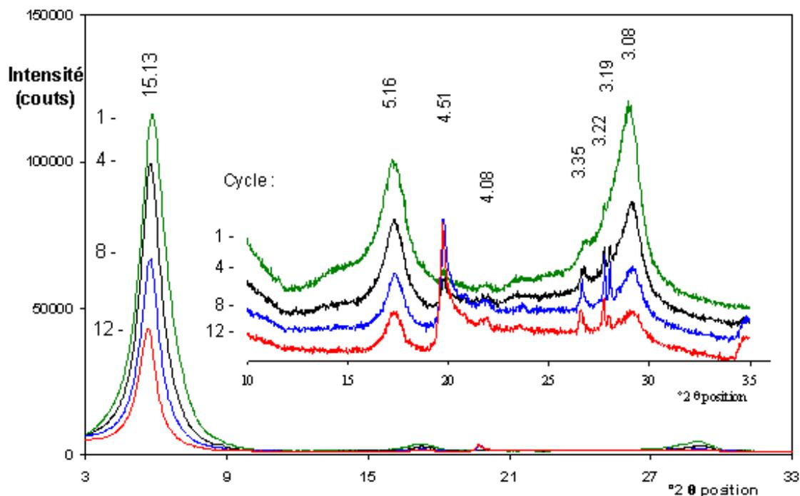
FIG. 2.7 – DRX sur lames orientées pour les échantillons  $ff_1$ ,  $ff_4$ ,  $ff_8$  et  $ff_{12}$ , agrandissement de la zone 10 à 35 °2θ. La distance interfoliaire  $d(\text{Å})$  est indexée pour chaque pic.
