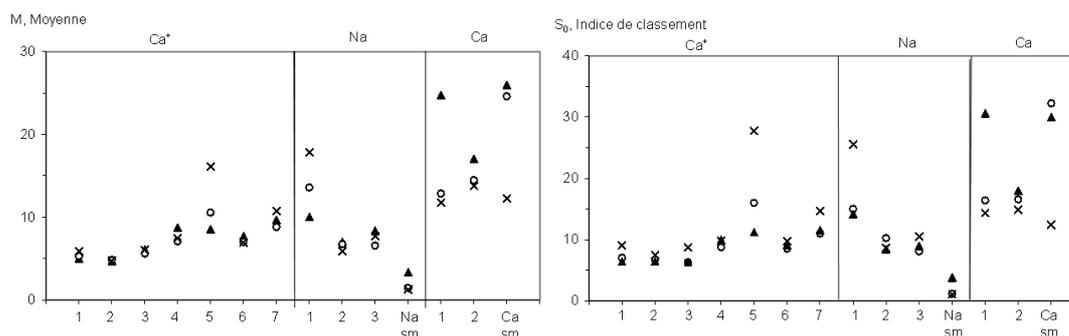
FIG. 5.5 – Evolution des indices granulométriques  $M$  (moyenne) et  $S_0$  (indice de classement) en fonction du temps d'hydratation :  $\blacktriangle$  : deux heures,  $\circ$  : une journée,  $\times$  : un mois.
