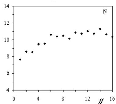
FIG. 2.8 – Evolution des caractéristiques minéralogiques déduite du pic  $d_{001}$  de la smectite en fonction des cycles d'extraction.
