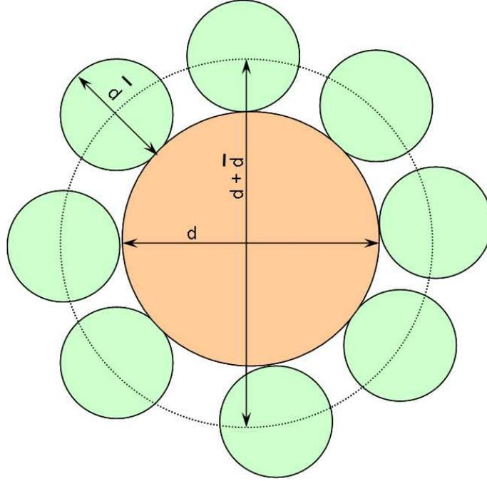
FIG. 3.24 – Cellule de base du modèle d'Ouchiyaama et Tanaka [106] pour le calcul de la fraction d'occupation d'une suspension bi-disperse de sphères, selon [55].
