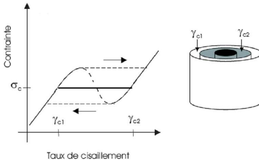
FIG. 1.23 – Illustration du "gradient-banding" selon Drappier [40] : bandes de cisaillement coexistant à une même contrainte dans la direction du gradient de vitesse dans le cas d'un plateau horizontal.
