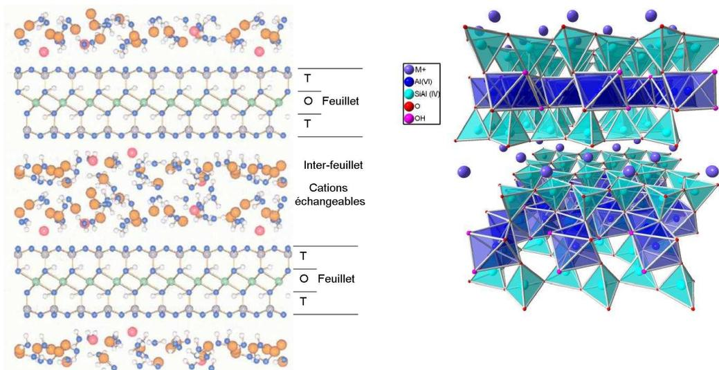
FIG. 1.3 – Représentation de la structure cristalline d'une smectite hydratée par Harding [60] et représentation simplifiée des tétraèdres et octaèdres par Claret [27].
