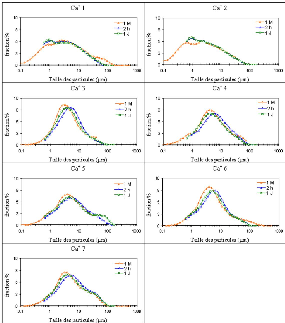
FIG. 22 – Distribution granulométrique obtenue par granulométrie laser pour des suspensions de bentonites calciques activées après deux heures (2 h), une journée (1 j) puis un mois d'hydratation (1 M).
