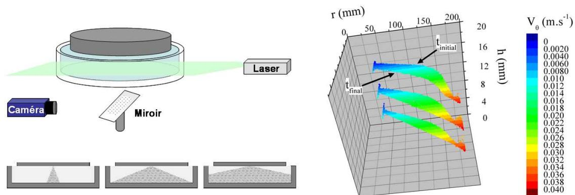
FIG. 1.25 – a : Configuration expérimentale de détermination par PIV du champ de vitesse dans un entrefer plan-plan. b : Représentation schématique de l'hétérogénéité d'écoulement entre les deux disques. c : Evolution des profils de vitesse tangentielle au cours du temps lors d'un passage de 40 à 2 rpm pour 3 plans horizontaux au sein de l'entrefer. D'après Jarny [66].
