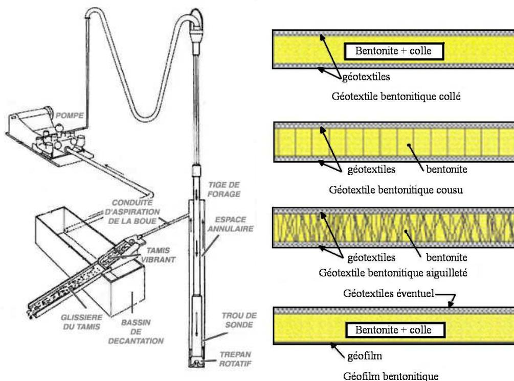
FIG. 1.2 – Utilisation industrielle des propriétés mécaniques de la bentonite. Exemples du cycle d'utilisation et de recyclage des boues de forage (d'après [www.cmmp.ucl.ac.uk](http://www.cmmp.ucl.ac.uk)) et des types de fabrication des géosynthétiques bentonitiques [37].
