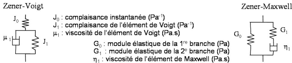
FIG. 4.11 – Schématisation du modèle de Zener suivant les représentations de Kelvin-Voigt et de Maxwell.
