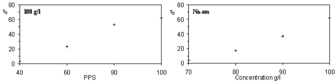
FIG. 4.9 – *Evaluation de la contraintes seuils ( $\tau_0$ ) au sens de Coussot [29] pour les 7 suspensions sélectionnées.*
