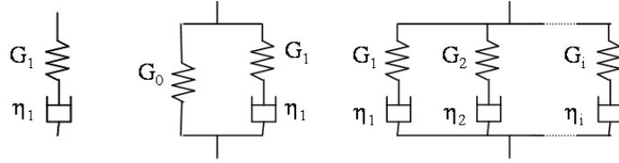
FIG. 1.31 – *Modèle de Maxwell, de Zener-Maxwell et de Maxwell généralisé pour un solide.*
