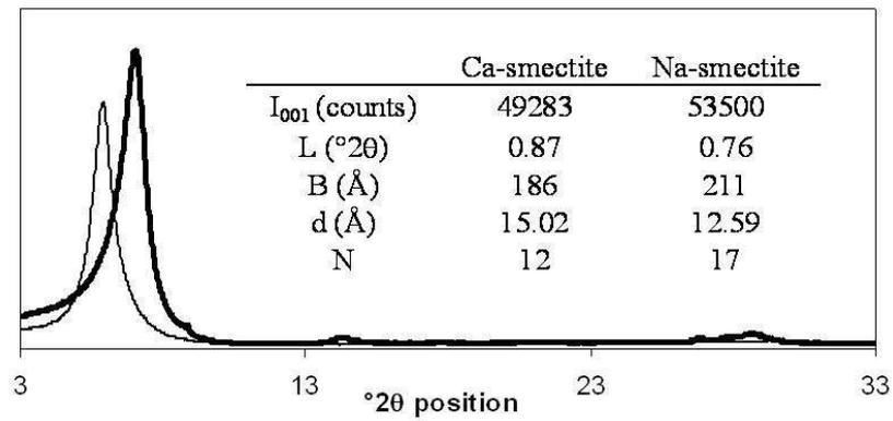
FIG. 2.13 – DRX sur lame orientée de Ca-sm et Na-sm et paramètres liés au pic principal  $d_{001}$  : intensité ( $I_{001}$ (counts)), espacement inter-feuillets  $d$ (Å), distance angulaire à mi-hauteur  $L$ ( $^{\circ}2\theta$ ), épaisseur  $B$ (Å) et nombre de plans  $N$  dans un ensemble cristallin.
