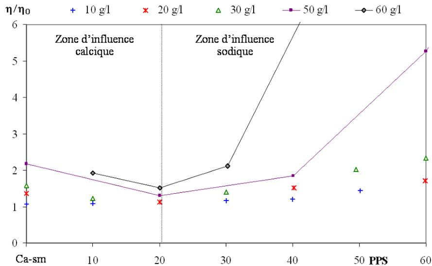
FIG. 3.22 – Evolution de la viscosité relative ( $\eta_r = \eta/\eta_0$ ) en fonction de la composition de la suspension (de Ca-sm à 60 PPS) pour diverses concentrations (10 g/l, 20 g/l, 30 g/l, 50 g/l et 60 g/l).
