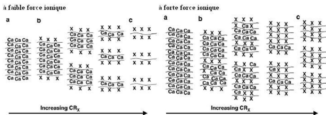
FIG. 1.10 – Modèle conceptuel de Pils et al. [118] illustrant la formation de cristallites respectivement à faible et forte force ionique (1 et 2). – : feuillet de smectite, Ca : ion calcium hydraté, x : cation monovalent hydraté.
