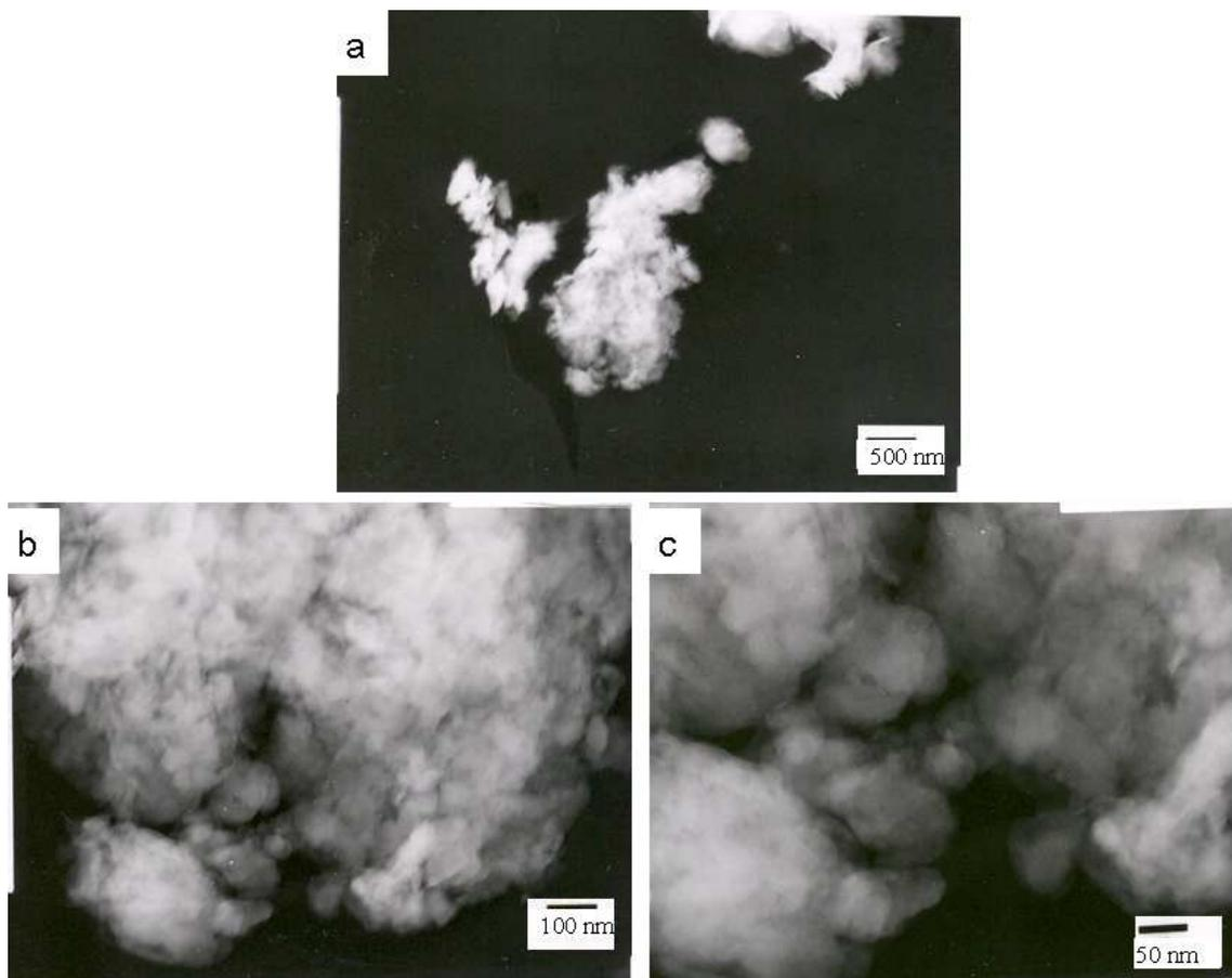
FIG. 2.16 – Observation MET de suspensions de Ca-sm ultrasonées, séchées 48 h à 50°C. Les photographies a, b et c sont des agrandissements successifs du même agrégat. (C. Boissart)
