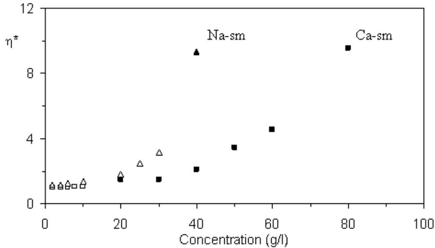
FIG. 3.11 – Evolution de  $\eta^*$  en fonction de la concentration pour des suspensions de Na-sm (▲) et Ca-sm (■). Les formes creuses (△ □) correspondent aux cas où  $\eta^* = \eta_r$ .
