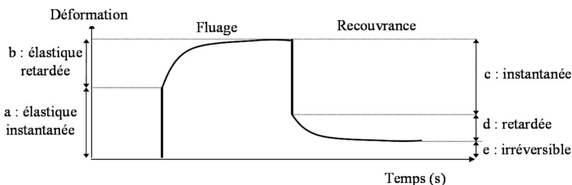
FIG. 1.28 – Paramètres de discrétisation d'un essai de fluage-recouvrance.
