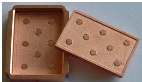
Figure 2-3 : Caloduc à plots
