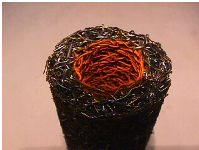
Figure n°50 : filtration de particules colorées pour la visualisation des zones de dépôt : les particules ne se fixent que sur la partie des fibres voyant l'anode.
