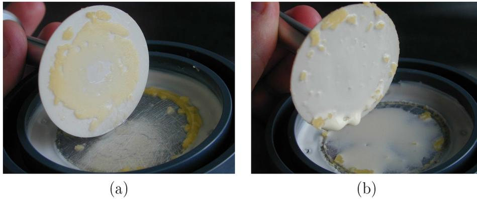
FIG. 4.20 – Discrimination entre les deux mécanismes de barattage selon l'aspect macroscopique de l'échantillon : (a) coexistence gel/barattage ( $D(4,3) = 32\mu\text{m}$ ,  $R_m = 2,7$ ); (b) coexistence émulsion/barattage ( $D(4,3) = 7\mu\text{m}$ ,  $R_m = 0,5$ ).
