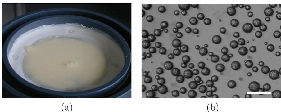
**FIG. 4.4** – (a) Aspect macroscopique de l'émulsion à l'issue d'une déformation d'amplitude  $\gamma_d = 1100\%$  appliquée pendant 5 heures à  $4^\circ C$  ; (b) photographie de microscopie optique de cet échantillon dilué - barre d'échelle  $50\mu m$ .
