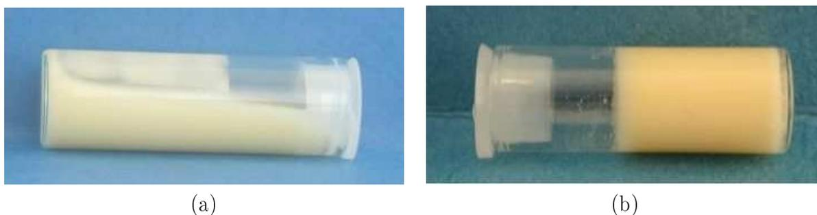
FIG. 3.3 – Photographies à 4°C de l'émulsion fluide de MGLA dans l'eau (a) et de l'émulsion devenue solide après passage à température ambiante (b).
