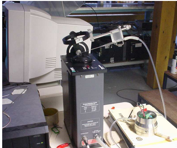
FIG. 2.2 – Photographie de la prise de pression totale en verre en rotation sur la soufflerie d'étalonnage
