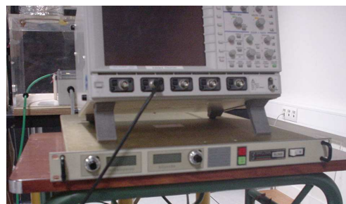
FIG. 2.7 – Photographie de l'alimentation continue positive SPELLMAN SL300
