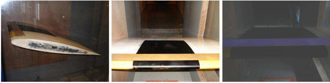
FIG. 3.34 – Profil ac0 équipé de l'actionneur DBD, installé dans la veine d'essais principale de la soufflerie Lucien Malavard
