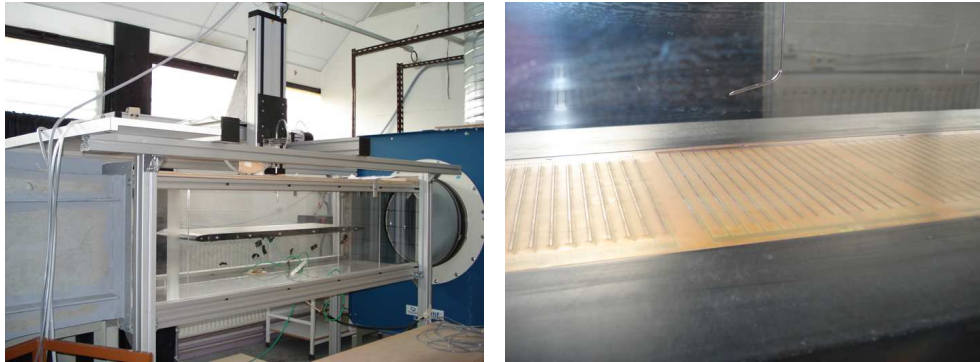
FIG. 3.19 – Photographies du montage de la plaque plane dans la soufflerie subsonique
