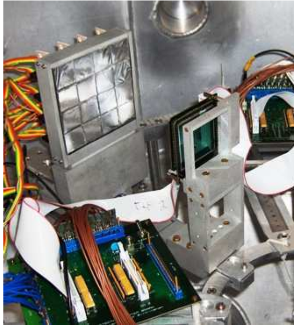
FIG. 4.7 – Vue d'ensemble de CHARISSA, les deux détecteurs Silicium sont visibles sur la droite, et à gauche, le mur de CsI, avec les photodiodes et les cartes de connexions électroniques.
