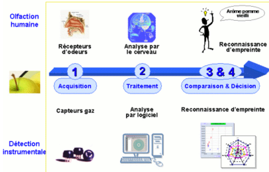
FIG. 1.27 – Analogie du fonctionnement du nez électronique et du nez humain.
