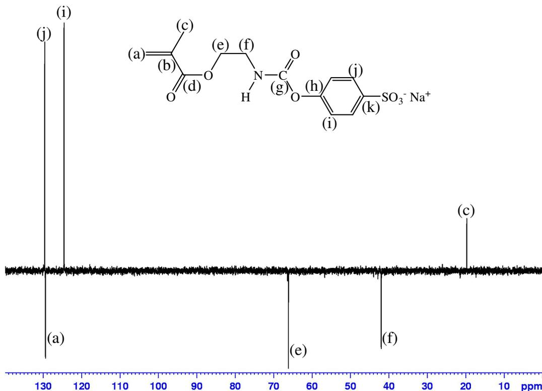
Figure 14 : Spectre RMN  $^{13}\text{C}$  DEPT 135 du 4-((méthacryloyloxy)éthyl)carbamoylbenzènesulfonate de sodium dans  $\text{D}_2\text{O}$ .
