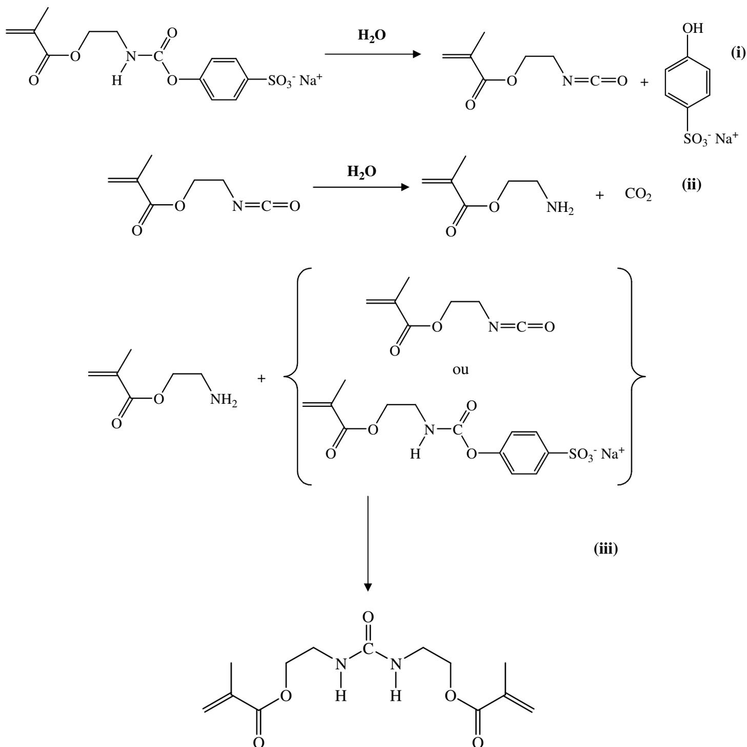
Schéma 24 : Mécanisme d'hydrolyse de l'IEMPhSO<sub>3</sub><sup>-</sup> dans l'eau.
