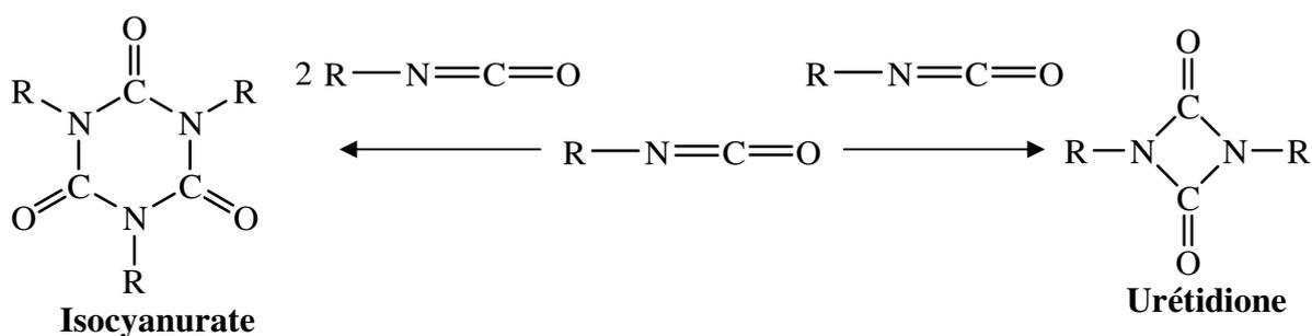
Schéma 8 : Réactions de cycloaddition à partir d'isocyanate.
