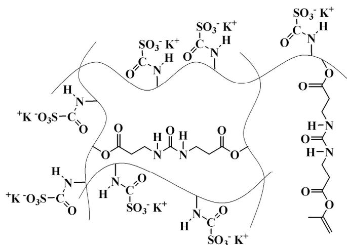
Schéma 18 : Structure de l'hydrogel.
