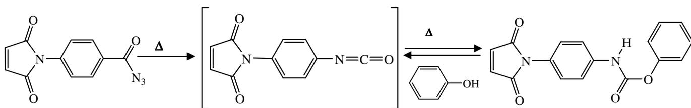
Schéma 14 : Synthèse d'un monomère maléimide porteur d'une fonction isocyanate bloqué.
