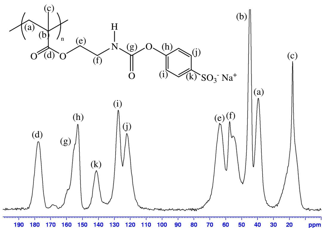
Figure 21 Spectre RMN <sup>13</sup>C à l'état solide du poly(IEMPhSO<sub>3</sub><sup>-</sup>).
