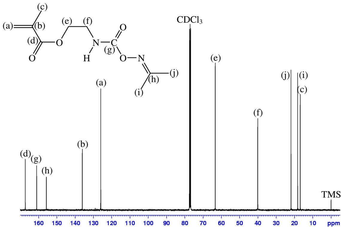
Figure 24 : Spectre RMN  $^{13}\text{C}$  de l'IEMAcOx dans  $\text{CDCl}_3$ .
