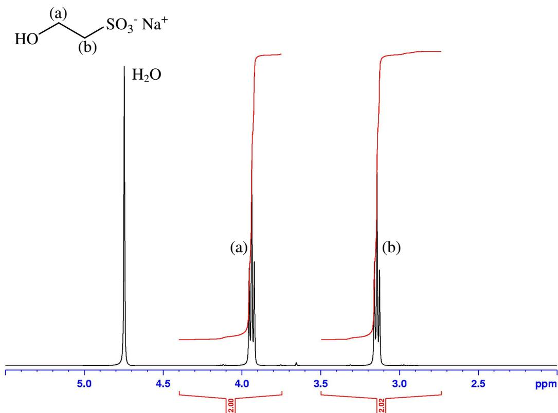
Figure 18 : Spectre RMN <sup>1</sup>H du 2-hydroxyéthanesulfonate de sodium dans D<sub>2</sub>O.
