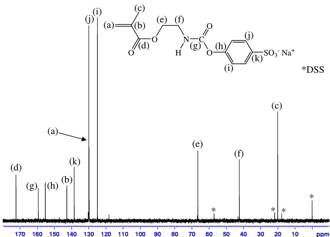
Figure 13 : Spectre RMN <sup>13</sup>C du 4-(méthacryloyloxy)éthylcarbamoylbenzènesulfonate de sodium dans D<sub>2</sub>O.
