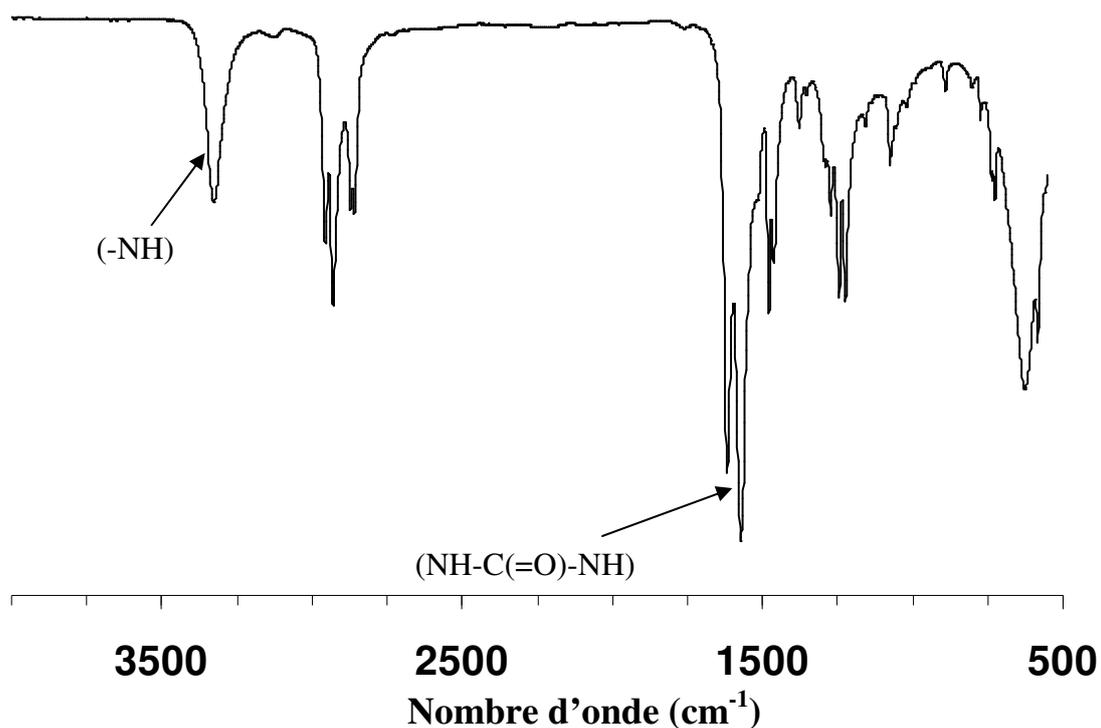
Figure 11 : Spectre IR-TF de la 1-butyl-3-hexylurée.
