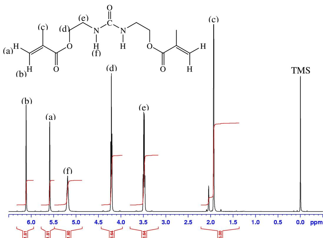
Figure 19 : Spectre RMN  $^1\text{H}$  du composé bisméthacrylate urée dans  $\text{CDCl}_3$ .
