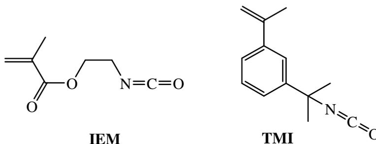
Schéma 12 : Structure des monomères IEM et TMI.
