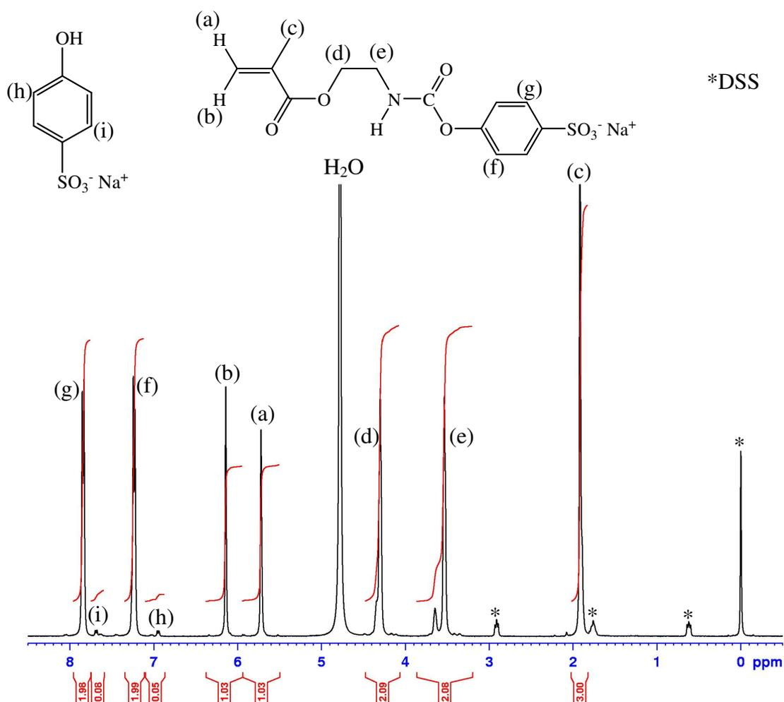
Le caractère hydrosoluble a pu être vérifié simplement en effectuant les analyses par spectroscopie RMN dans  $\text{D}_2\text{O}$  ; les échantillons sont parfaitement limpides. Le spectre RMN  $^1\text{H}$  permet de retrouver l'ensemble des déplacements chimiques attendus pour ce composé, notamment les signaux à 5,72 et 6,14 ppm correspondant aux deux protons vinyliques de la
