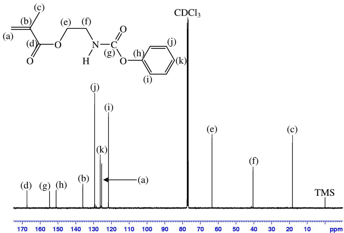
Figure 23 : Spectre RMN  $^{13}\text{C}$  de l'IEMPh dans  $\text{CDCl}_3$ .
