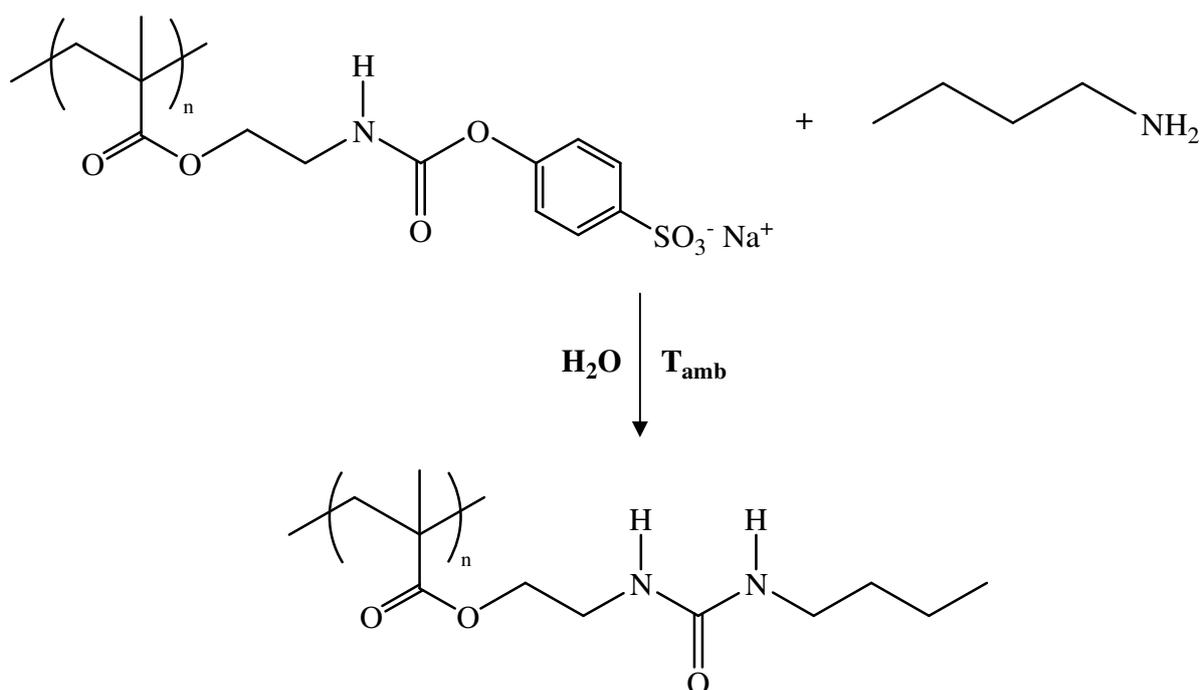
Schéma 27 : Réaction du poly(IEMPhSO $_3^-$ ) avec la n-butylamine
