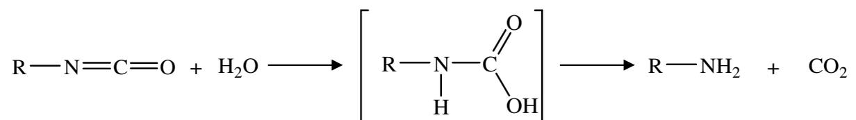
Schéma 7 : Décarboxylation des isocyanates dans l'eau.
