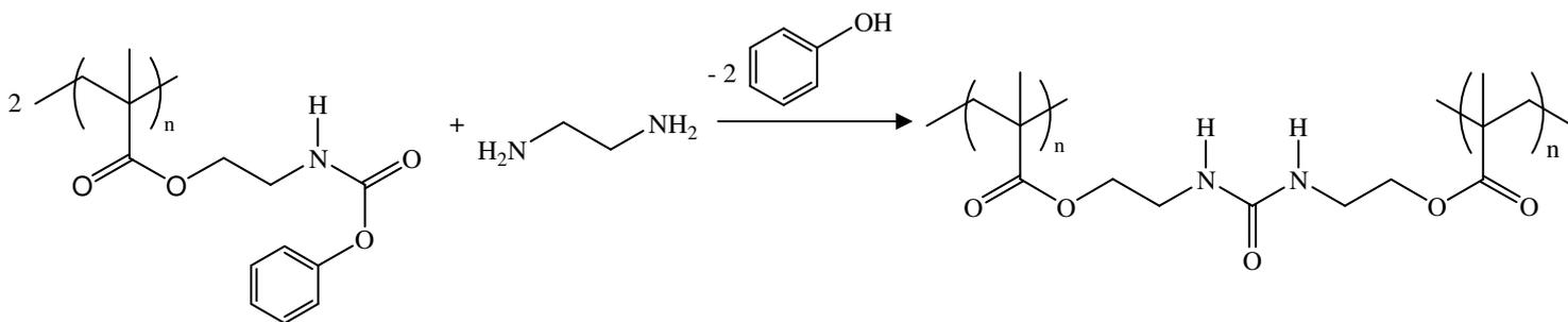
Schéma 13 : Réticulation de polymères portant des fonctions isocyanate bloqué par le phénol.
