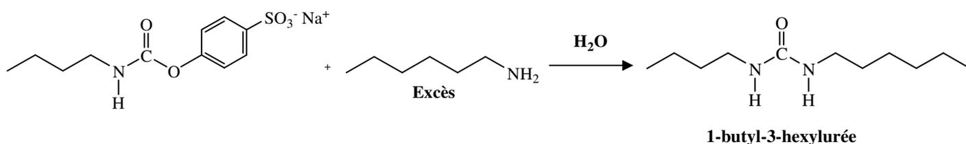
Schéma 22 : Réaction entre  $\text{BuPhSO}_3^-$  et la n-hexylamine.
