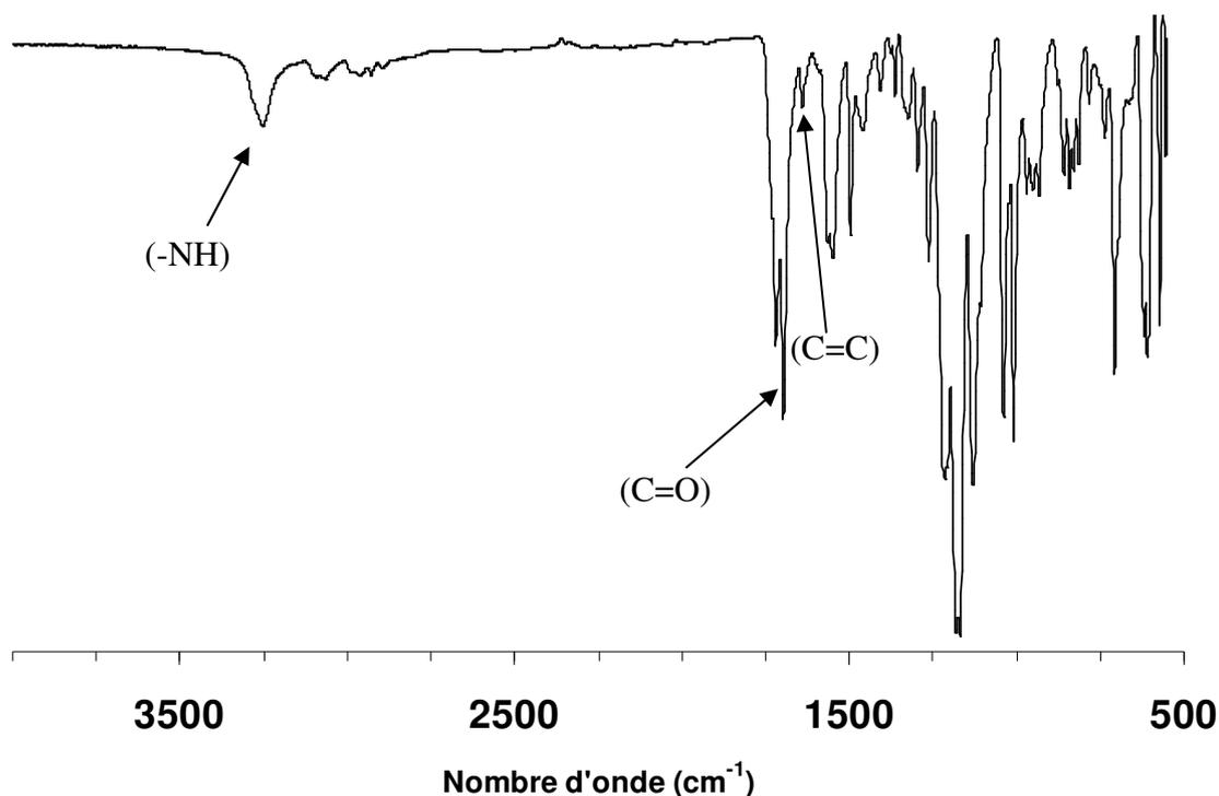
Figure 15 : Spectre IR-TF du 4-((méthacryloyloxy)éthyl)carbamoylbenzènesulfonate de sodium.
