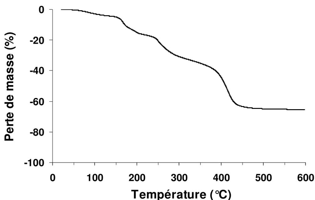
Figure 4 : Thermogramme d'un échantillon sec d'hydrogel.
