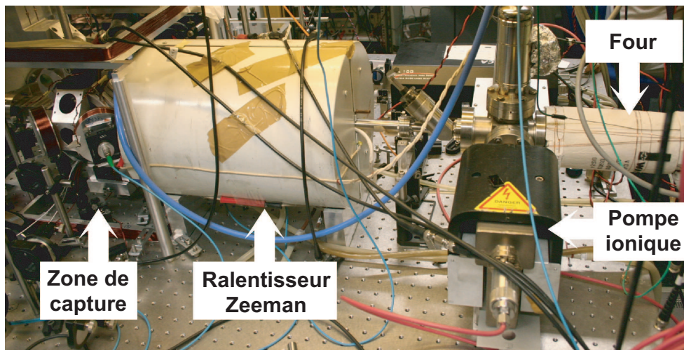
FIG. 4.3 – Photo du montage principal, comprenant le four principal, le ralentisseur Zeeman et la zone de capture et d'interrogation.
